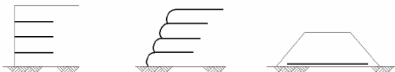
Σχήμα 10-2 : Χαρακτηριστικές περιπτώσεις εφαρμογής των γεωφασμάτων κατά τον σχεδιασμό μίας τομής με το πρόγραμμα Plaxis
