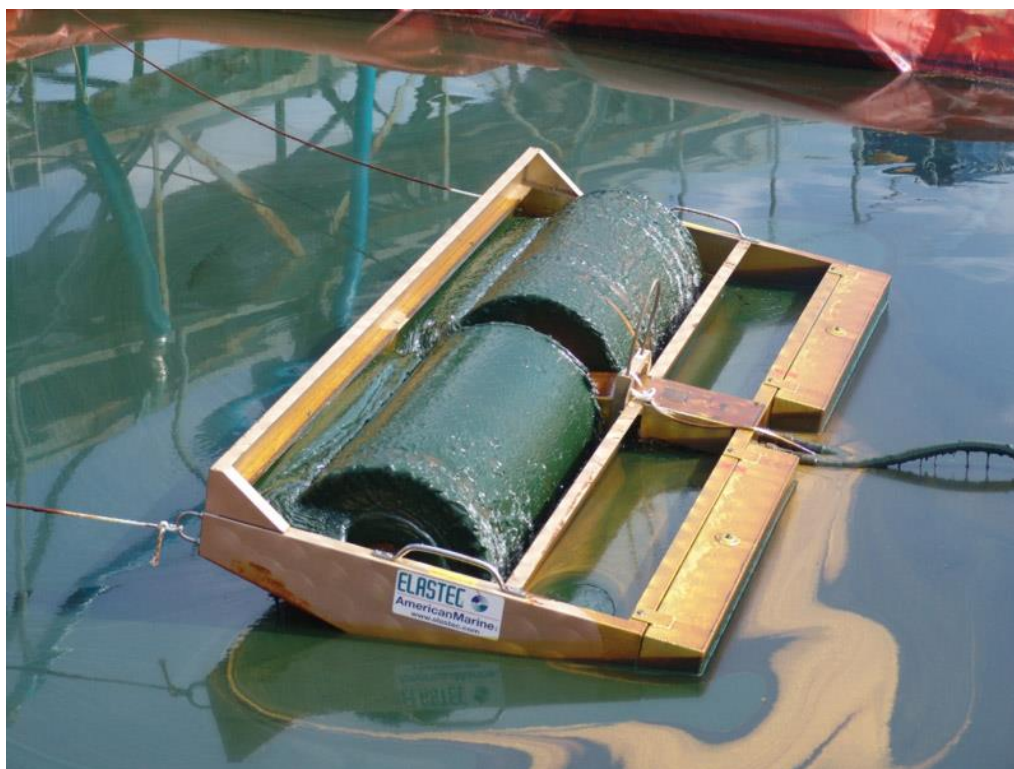
Εικόνα 6.3: ελαιόφιλος περιστρεφόμενος εξαφριστής
