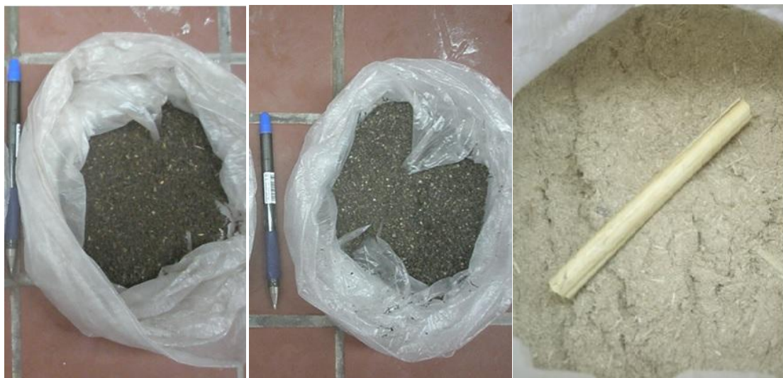
Εικόνα 4.8 Στερεά δείγματα που προέκυψαν από την προετοιμασία των στερεών υλικών. Από αριστερά προς τα δεξιά είναι το δείγμα C, το δείγμα Ι και το δείγμα Κ λ συγκριτικά με στέλεχος καλαμιάς που αποτελεί το δείγμα Κ.
