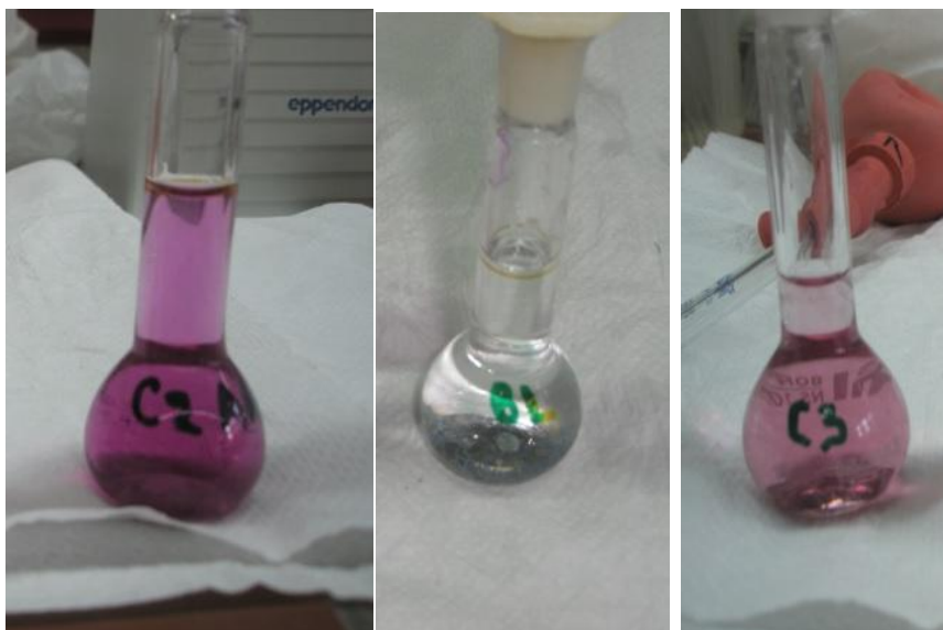
Εικόνα 4.9 Δείγματα για φασματοφωτομετρική ανάλυση μετά την προσθήκη DPC. Από αριστερά προς τα δεξιά εμφανίζεται σωστά χρωματισμένο δείγμα, «τυφλό» δείγμα και δείγμα με χρωματική αλλοίωση.
