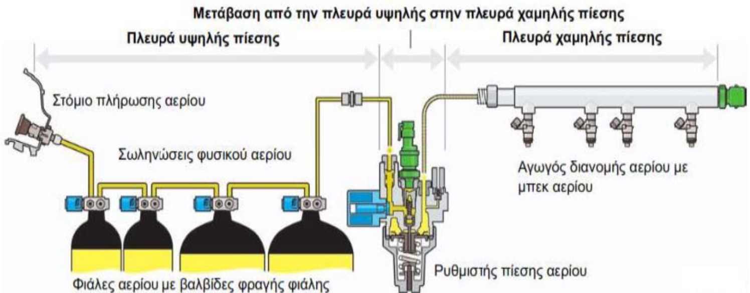
Εικόνα 18: Σχηματική διάταξη εξαρτημάτων συστήματος τροφοδοσίας αερίου
