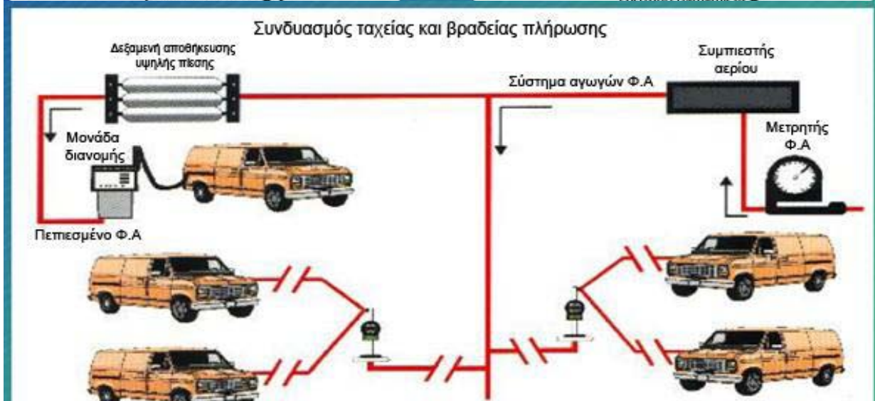
Εικόνα 13: Διαγράμματα πρατηρίων με εγκατάσταση φυσικού αερίου
