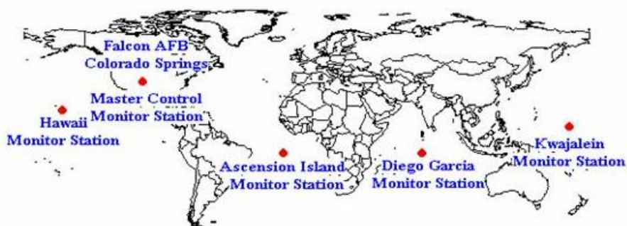
Οι επίγειοι σταθμοί του GPS
