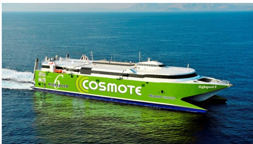
Σχήμα 1.3. Ε/Γ-Ο/Γ πλοίο τύπου καταμαράν με μέγιστη ταχύτητα 40 κόμβους.
