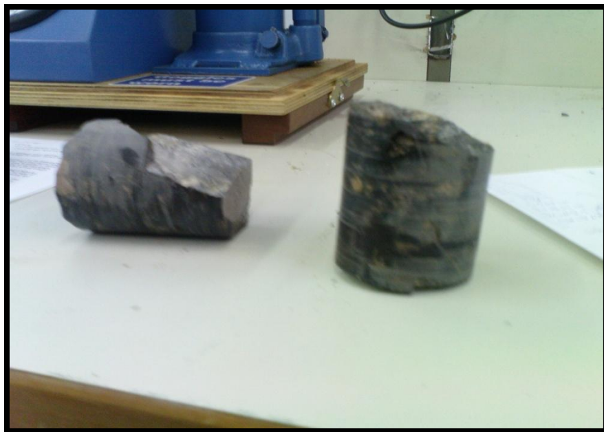
Εικόνα 4.9: Πυρήνας μετά τη διαμετρική φόρτιση του δοκιμίου.
