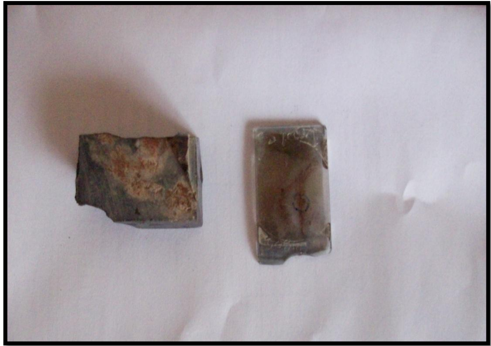
Εικόνα 4.16. Τομή του ασβεστολίθου οροφής.
