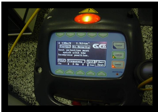
5.6.laser της εταιρείας EL.EN. LQS και Free Nd:YAG laser, 1064 nm, (100 ns και 100 μs)
