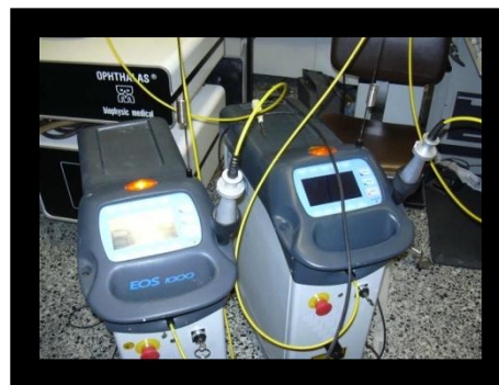
5.6.laser της εταιρείας EL.EN. LQS και Free Nd:YAG laser, 1064 nm, (100 ns και 100 μs)
