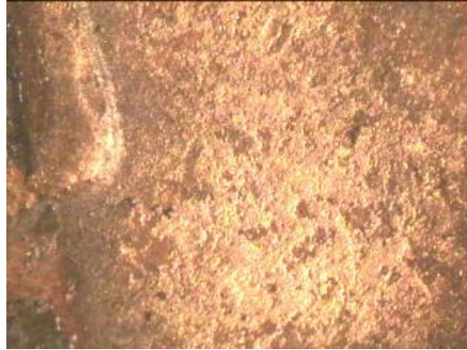
Φώτο:Κυπριακό νόμισμα 1960.Εφαρμογή Nd:YAG 532 nm.Διακρίνεται η απομάκρυνση όλων των οξειδώσεων αλλά υπάρχει ταυτόχρονα υπερκαθαρισμός της επιφάνειας που είχε ως αποτέλεσμα την καταστροφή της πατίνας.
