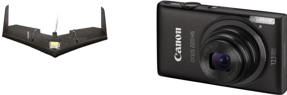
Εικόνα 44: Το μη επανδρωμένο σύστημα αεροφωτογράφισης Swinglet Cam και η ψηφιακή μηχανή Canon IXUS 220HS
