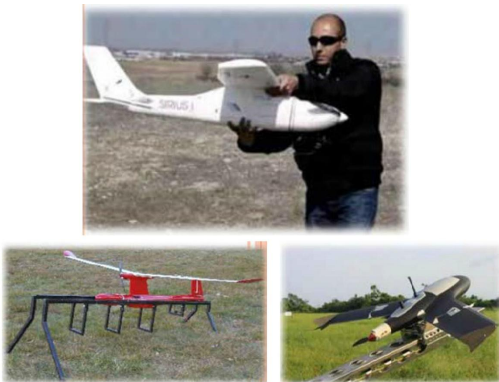
Εικόνα 9: Παραδείγματα του τρόπου απογείωσης των ΜΕΕΠ
