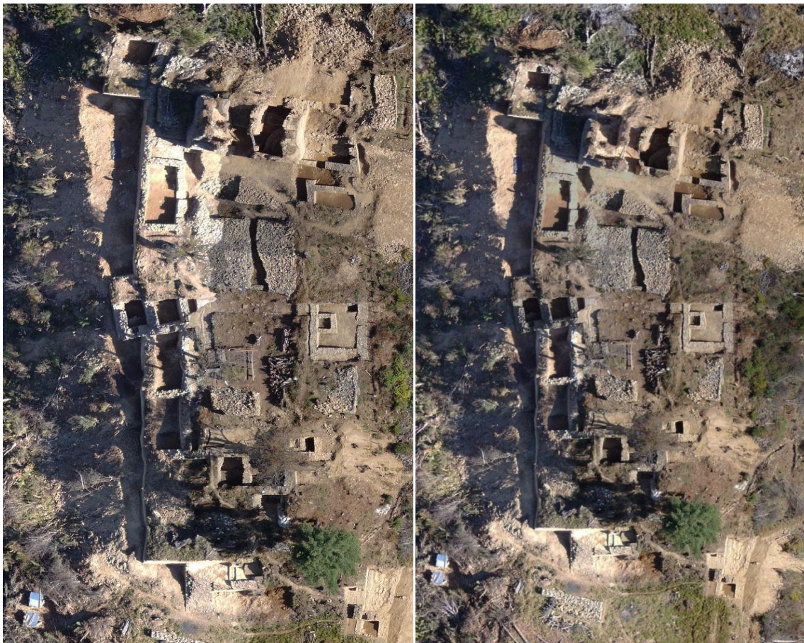
Εικόνα 17: Ορθοφωτογραφία της περιοχής του Drapham Zhong βασισμένη σε UAV εικόνες και σε ΨΜΕ που δημιουργήθηκε αυτόματα και ορθοφωτογραφία της περιοχής του Drapham Zhong βασισμένη σε UAV εικόνες και σε ΨΜΕ (ψηφιακό που δημιουργήθηκε χειροκίνητα (Bláha, 2010; Eisenbeiss, 2010; Sauerbier, 2010; Grün, 2010))
