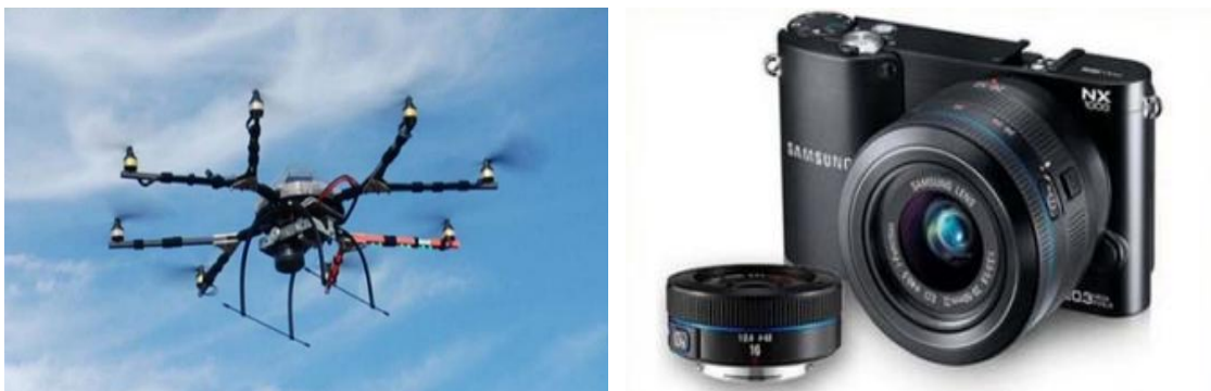
Εικόνα 30: Το μη επανδρωμένο σύστημα αεροφωτογράφισης Octocopter και η ψηφιακή μηχανή Samsung NX1000
