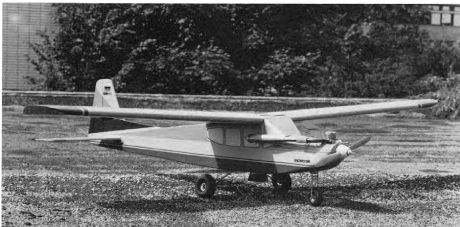
Εικόνα 5: ΜΕΕΠ σταθερών πτερυγίων από την εταιρεία Hegi (Przybilla και Wester-Ebbinghaus, 1979)
