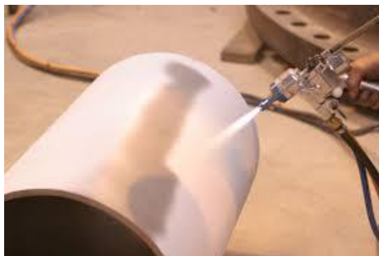
Εικόνα 31: Γαλβάνισμα με ψεκασμό ψευδαργύρου
