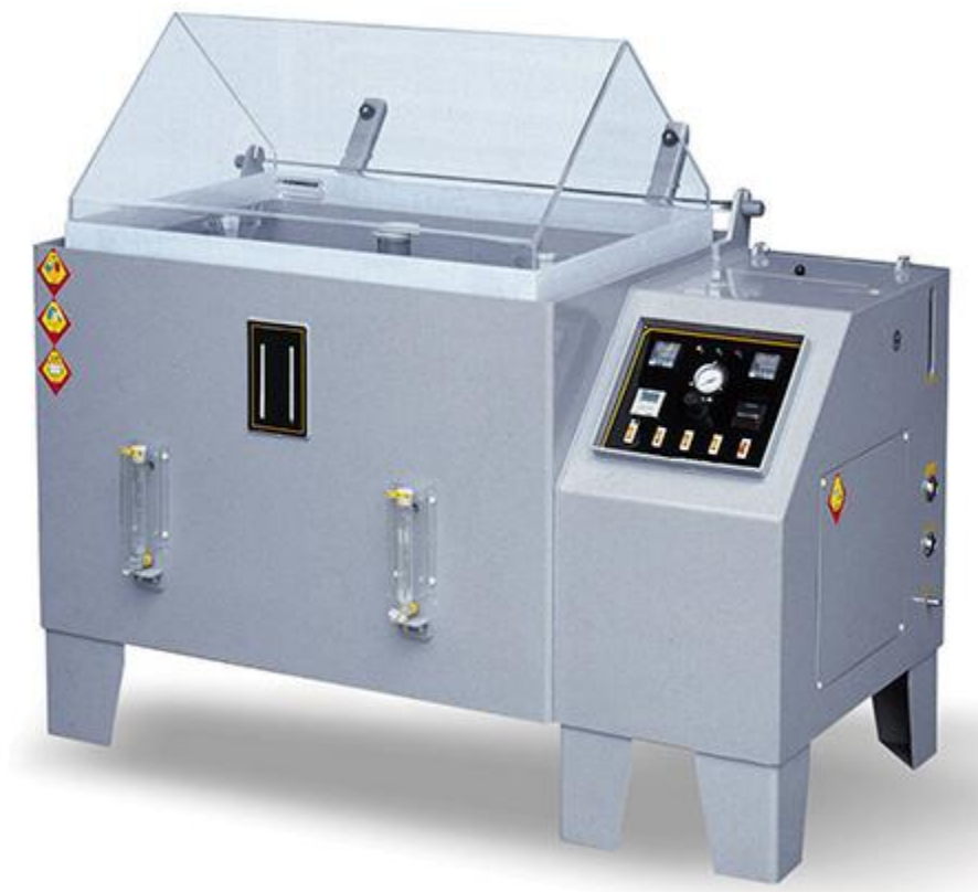
Εικόνα 32: Μηχάνημα ψεκασμού αλατονέφωσης
