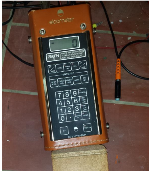
Εικόνα 32: Παχύμετρο δινορευμάτων που χρησιμοποιήθηκε στο παρόν πείραμα
