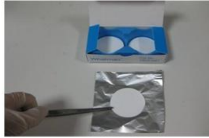
Εικόνες 3.25 και 3.26: Φιλτράκια GFC και προετοιμασία πριν τους φούρνους
