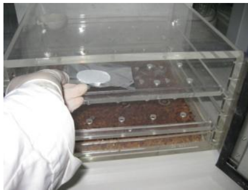
Εικόνα 3.32: Τοποθέτηση του προξηραμένου φίλτρου στον ξηραντήρα
