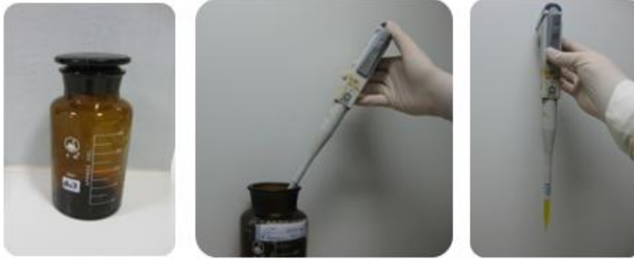
Εικόνες 3.12, 3.13 και 3.14: Διάλυμα εξασθενούς χρωμίου και λήψη μέσω πιπέτας
