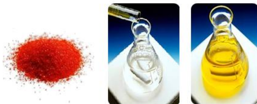
Εικόνες 3.9, 3.10 και 3.11: Διαδικασία παρασκευής διαλύματος K_2Cr_2O_7
