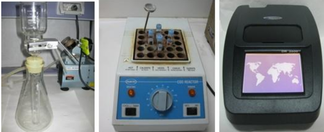
Εικόνες 3.37, 3.38 και 3.39: Συσκευή διήθησης, χωνευτής COD και φασματοφωτόμετρο HACH
