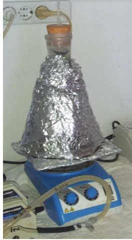
Εικόνα 3-2: Αναερόβιος αντιδραστήρας κωνικού σχήματος
