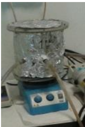
Εικόνα 3-1: Αναερόβιος αντιδραστήρας κυλινδρικού σχήματος
