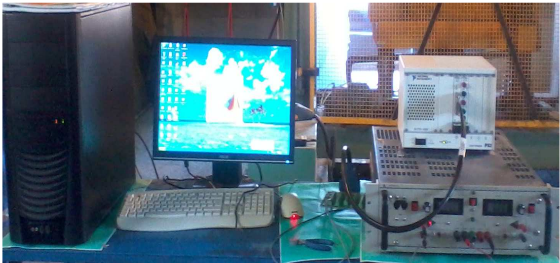
Εικόνα 2-3: Εργαστηριακός υστερησιογράφος του εργαστηρίου Μεταλλογνωσίας, ο οποίος καταγράφει τους βρόχους υστέρησης και προσδιορίζει την διαφορική μαγνητική διαπερατότητα.
