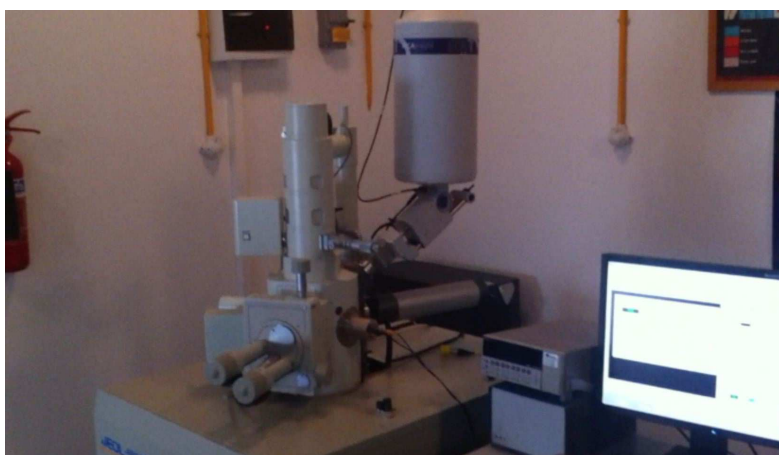
Εικόνα 2-12: Ηλεκτρονικό μικροσκόπιο σάρωσης (SEM) τύπου Jeol GSM 6380-LV.
