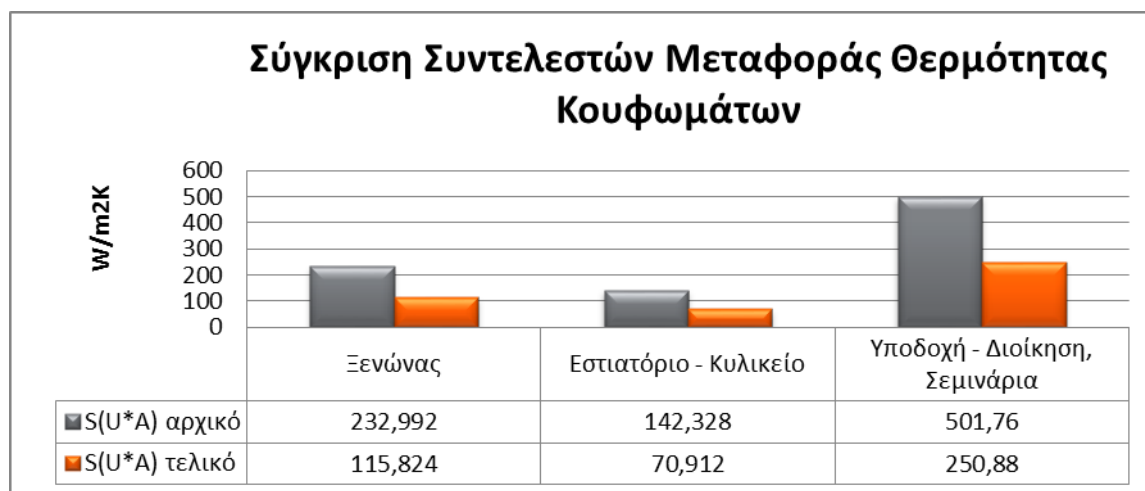
Γράφημα 5.6: Σύγκριση τιμών, μεταφοράς θερμότητας για το σύνολο των κουφωμάτων του κτιρίου του Ξενώνα (Κ1), του Εστιατόριου – Κυλικείου (Κ2) και των κτιρίων Υποδοχής – Διοίκησης και Σεμιναρίων που λαμβάνονται ως ένα (Κ3).
