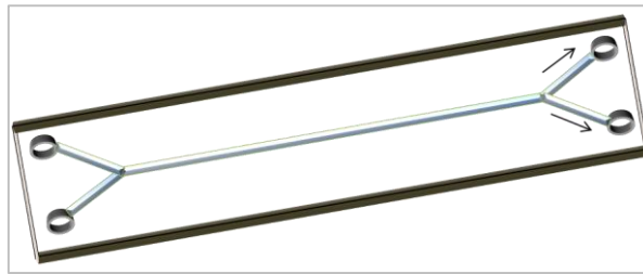
Εικόνα 5.6 Μικροροϊκό σύστημα το οποίο θα χρησιμοποιηθεί στην πειραματική διάταξη για προσομοίωση ενός αιμοφόρου αγγείου.
