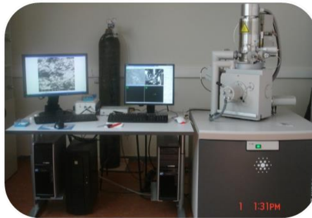
Εικόνα 4.7 Ηλεκτρονικό μικροσκόπιο σάρωσης του Τομέα Φυσικής της Σχολής Εφαρμοσμένων Μαθηματικών & Φυσικών Επιστημών (Ε.Μ.Π.), στο οποίο φαίνεται η στήλη των ηλεκτρονίων, ο θάλαμος του δείγματος, ο ανιχνευτής EDS, η ηλεκτρονική κονσόλα και οι οθόνες οπτικής απεικόνισης.
