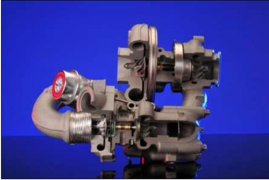
Σχήμα 2.5: Εφαρμογή διβάθμιας στροβιλο-υπερπλήρωσης της εταιρίας BorgWarner με βαλβίδα παράκαμψης στο ζεύγος χαμηλής πίεσης (η βαλβίδα παράκαμψης είναι το εξάρτημα με την κόκκινη διαμόρφωση στο επάνω μέρος)
