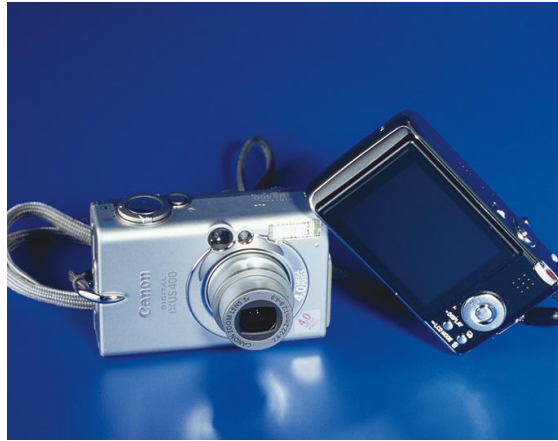
Εικόνα 2-21: Οι συμπαγείς κάμερες είναι ακατάλληλες για οδοντιατρική χρήση λόγω του φαινομένου της παράλλαξης [76].
