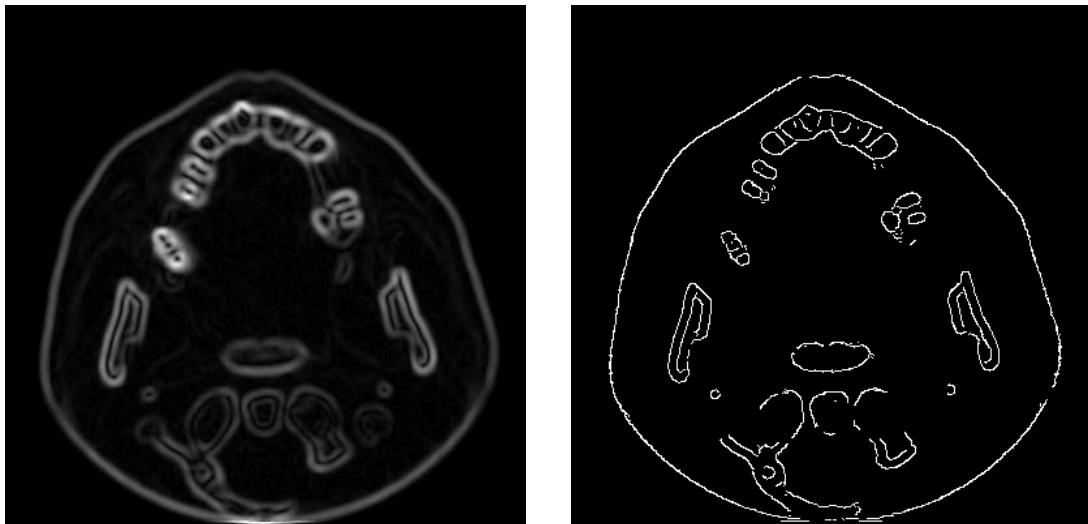
Εικόνα 5-8: Μέτρο της παράγωγου της εικόνας και δυαδική εικόνα ακμών.
