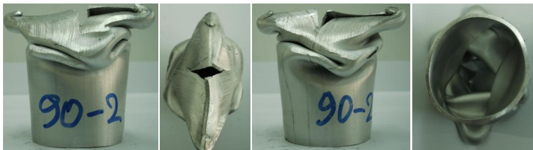
Εικόνα 3.4 Τελικές όψεις του δοκιμίου Φ50x2 -90 _2, μετά την κατάρρευση.
