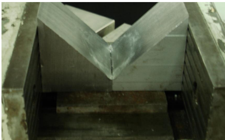
Εικόνα 2.10 Βάση τοποθετημένη πάνω στην πλάκα εντός της μέγγενης.
