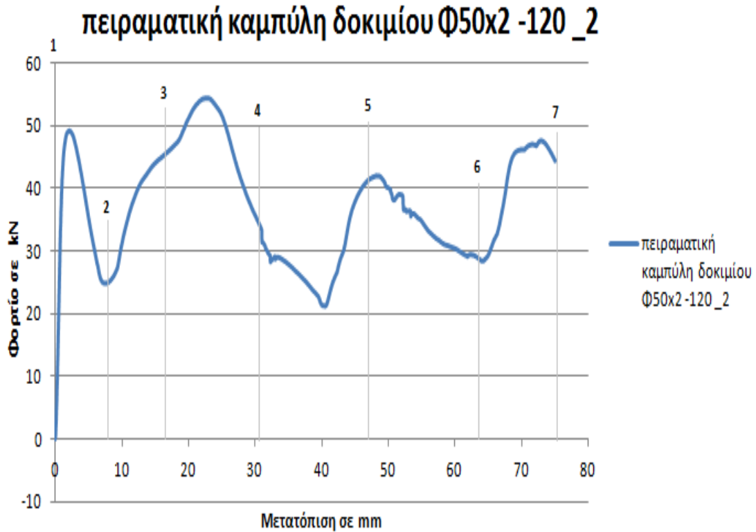
Διάγραμμα 3.20 Πειραματική καμπύλη φορτίου – μετατόπισης για το 2 ο κυλινδρικό δοκίμιο, με γωνία κορυφής 120°.
