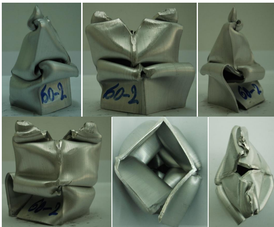
εικόνα 3.20 Τελικές όψεις του δοκιμίου 40x40x2-60_Ioxos_2, μετά την κατάρρευση.
