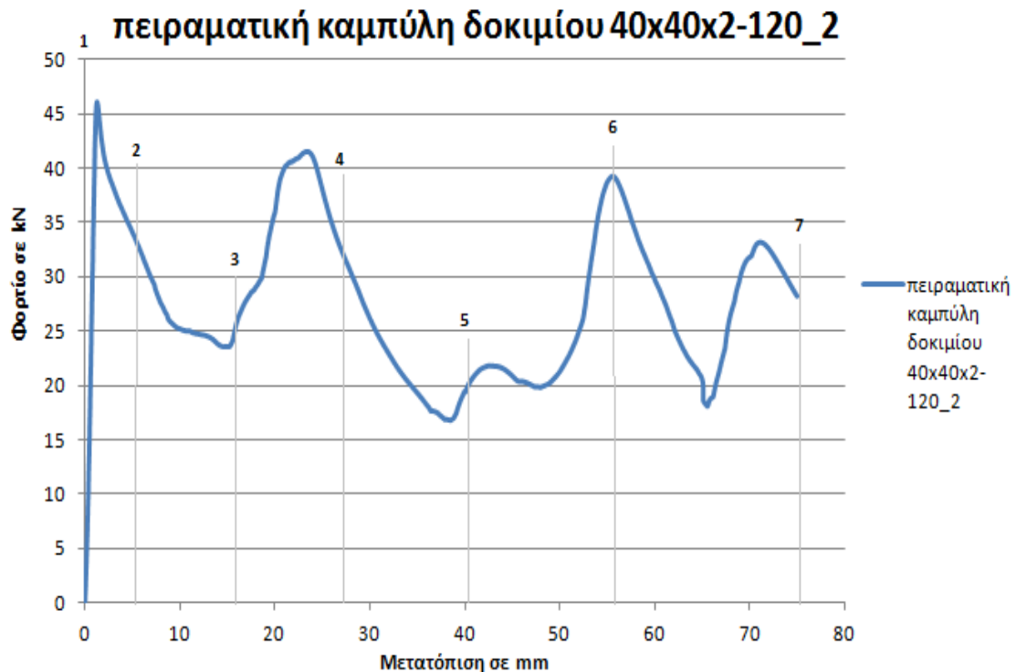
Διάγραμμα 3.26 Πειραματική καμπύλη φορτίου – μετατόπισης για το 2 ο τετραγωνικό δοκίμιο, με γωνία κορυφής 120°.
