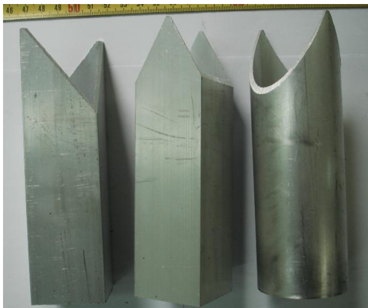
Εικόνα 2.1 Αριστερά λοξός τετραγωνικός, στο κέντρο απλός τετραγωνικός και δεξιά κυλινδρικός σωλήνας .
