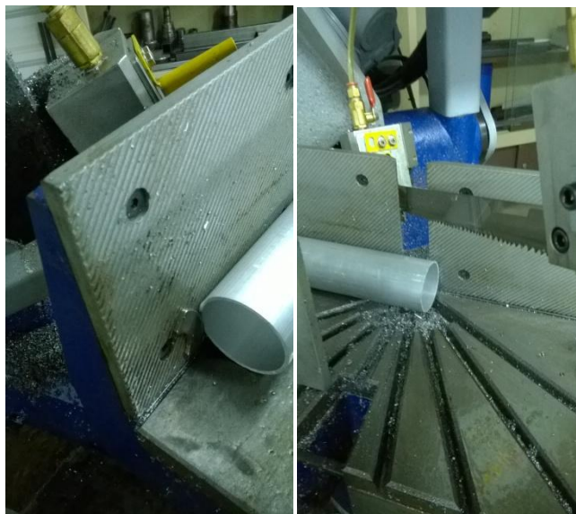
Εικόνα 2.11 Τοποθέτηση κυλινδρικού δοκιμίου στη μηχανή κοπής και χρήση αποστατήρα για τη συμμετρική διαμόρφωση της γωνίας κορυφής του.
