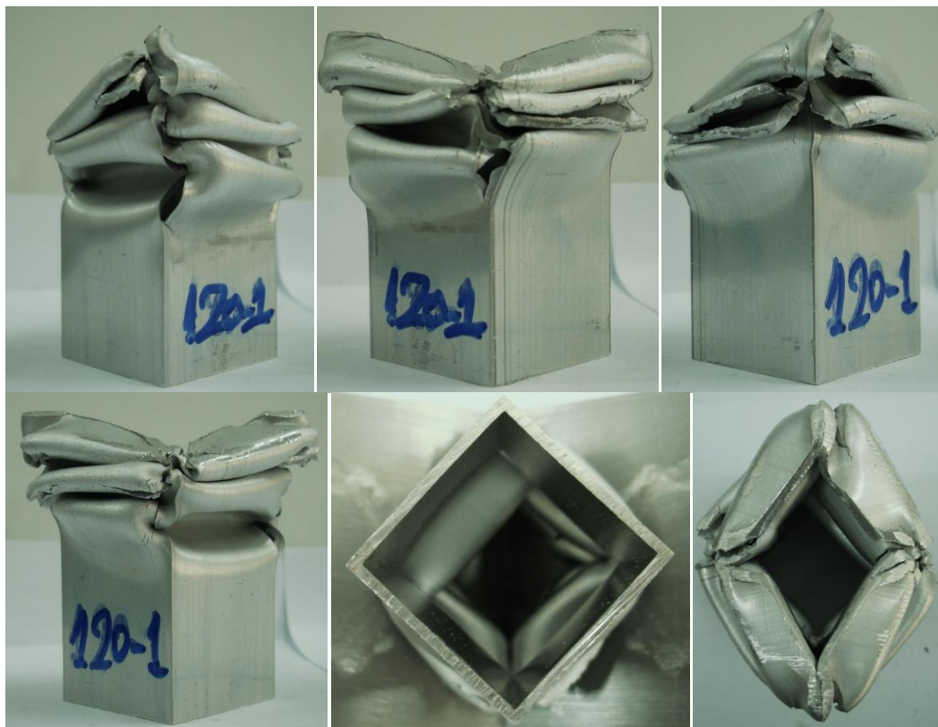
Εικόνα 3.30 Τελικές όψεις του δοκιμίου 40x40x2-120_1oxos_1, μετά την κατάρρευση.
