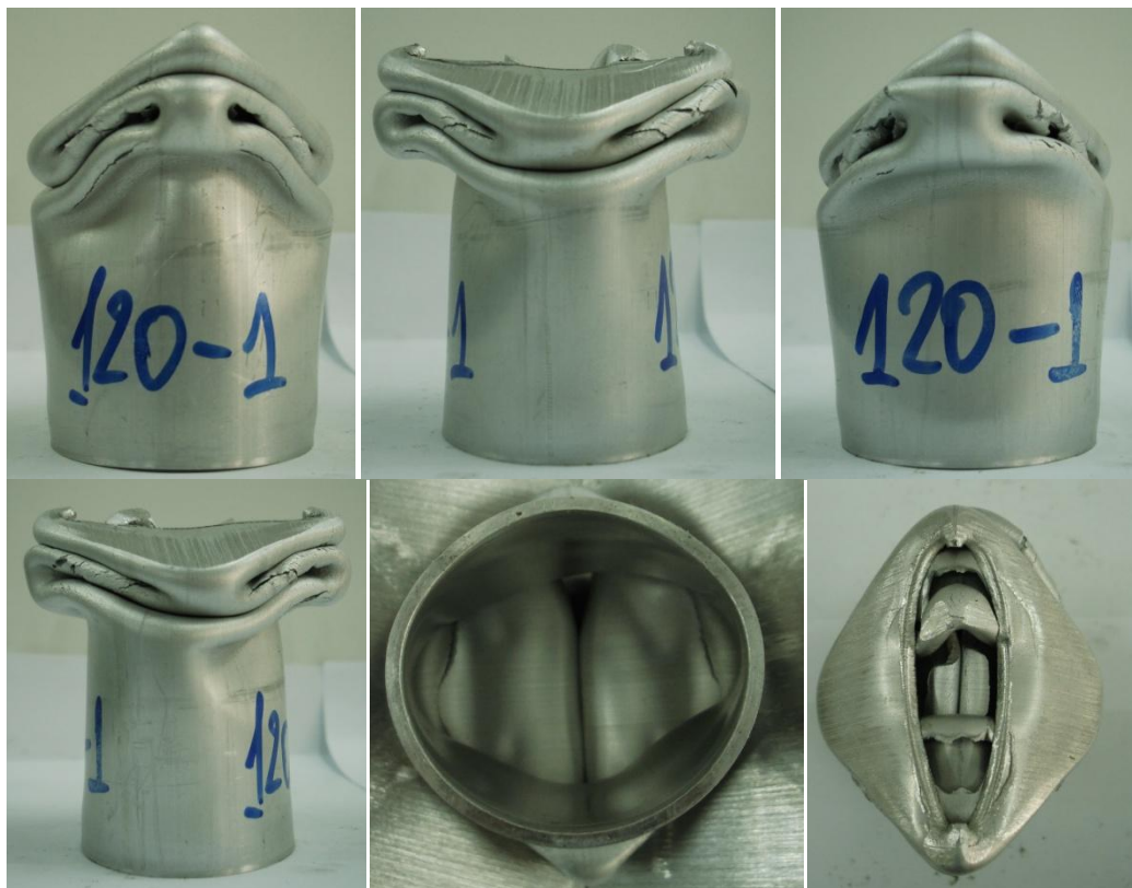
Εικόνα 3.26 Τελικές όψεις του δοκιμίου Φ50x2 -120 _1, μετά την κατάρρευση.
