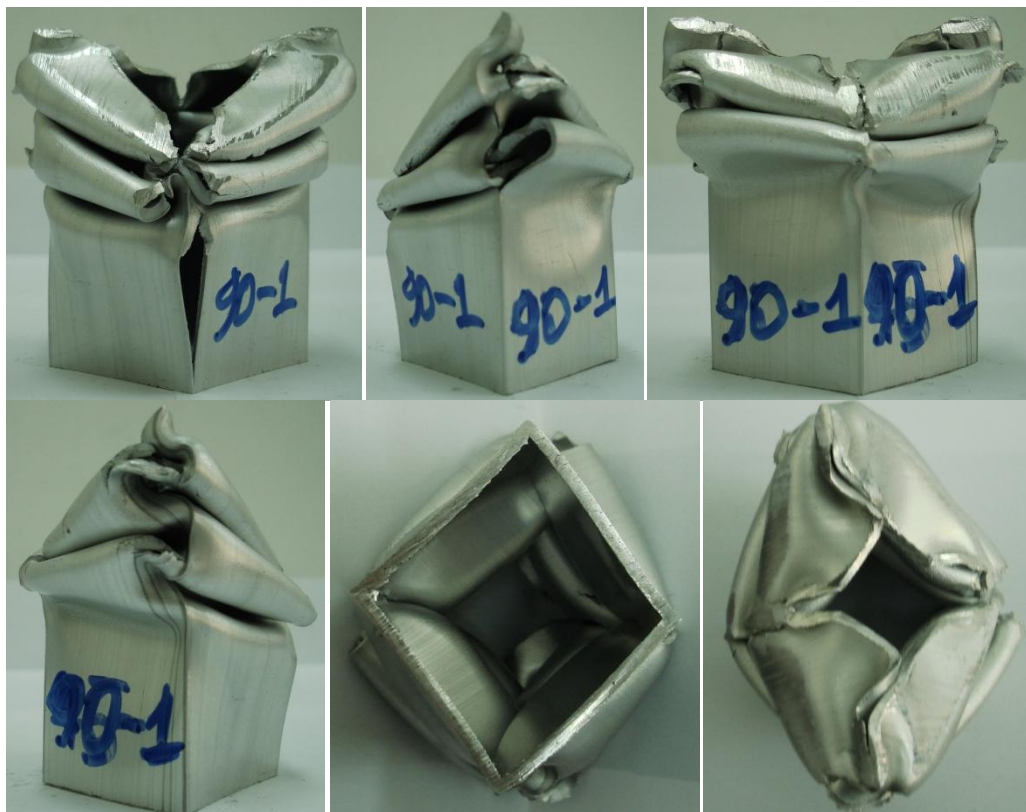
Εικόνα 3.6 Τελικές όψεις του δοκιμίου 40x40x2-90_1oxos_1, μετά την κατάρρευση.
