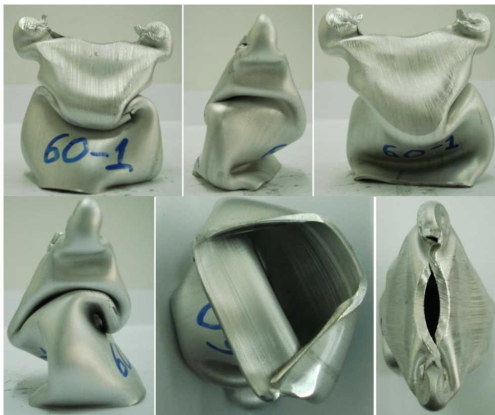
Εικόνα 3.14 Τελικές όψεις του δοκιμίου Φ50x2 -60 _1, μετά την κατάρρευση.
