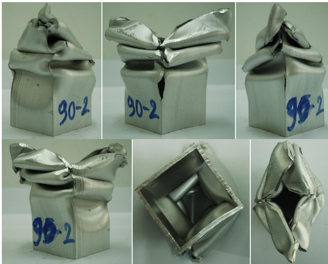
Εικόνα 3.8 Τελικές όψεις του δοκιμίου 40x40x2-90_loxos_2, μετά την κατάρρευση.
