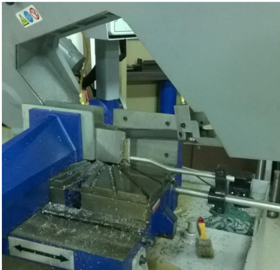
Εικόνα 2.5 Μηχανή κοπής κατά τη διάρκεια της κατεργασίας για τη δημιουργία των εδράσεων.
