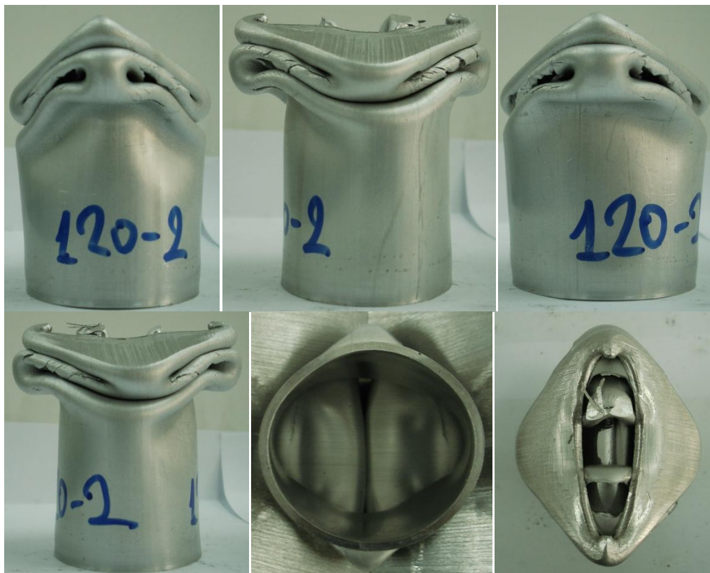
Εικόνα 3.28 Τελικές όψεις του δοκιμίου Φ50x2 -120_2, μετά την κατάρρευση.
