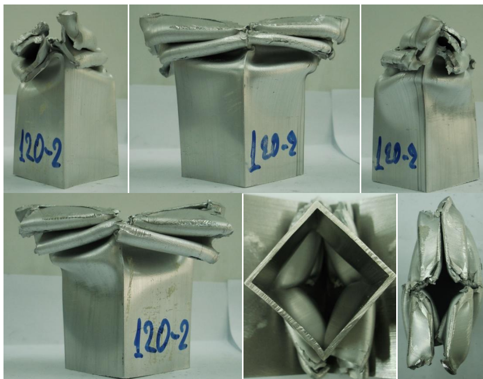
Εικόνα 3.32 Τελικές όψεις του δοκιμίου 40x40x2-120_1oxos_2, μετά την κατάρρευση.
