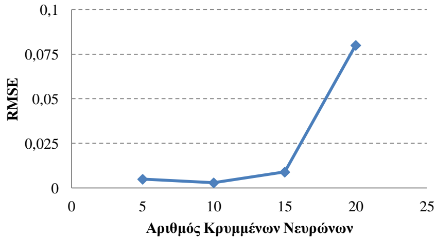
Σχήμα 5.3 Μεταβολή μέσου τετραγωνικού σφάλματος (RMSE), με την αύξηση των κρυμμένων νευρώνων.
