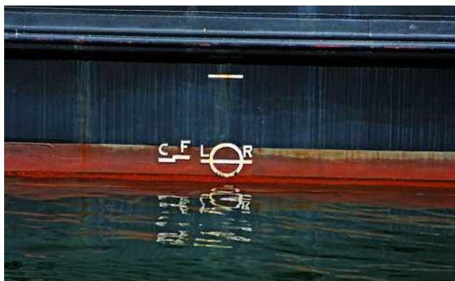
Εικ.3 έλεγχος της κατάστασης της σήμανσης των συμβόλων Γραμμής Φορτώσεως
