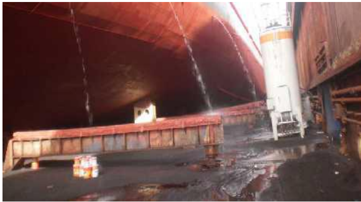
εικ.4 Έλεγχος κατάστασης τρόπιδας, παρατροπιδίων, αντιδιατοιχιστικών πτερυγίων, αναρροφήσεων, ευδαίων και των ανοιγμάτων προωραίων ελίκων (bow thrusters).
