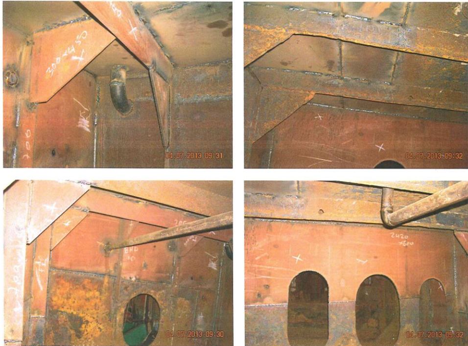
εικ.5 Έλεγχος κατάστασης δεξαμενών και φρακτών
