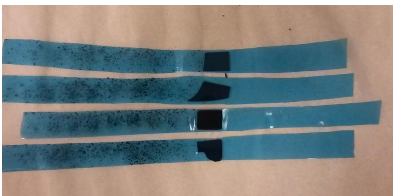
Εικόνα 2-3: Επικόλληση της κολλητικής ταινίας με το γραφίτη επάνω σε καθαρή επιφάνεια υποστρώματος
