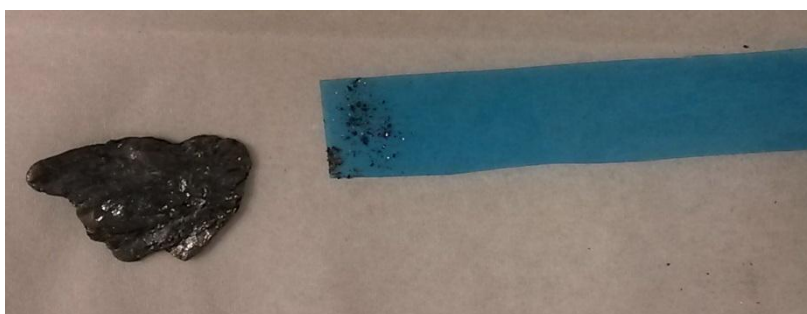
Εικόνα 2-2: Ο γραφίτης έχει τοποθετηθεί στην κολλητική ταινία
