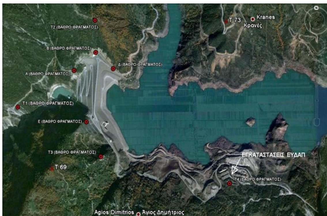
Σχήμα 2.4: Πρωτεύων και δευτερεύων τριγωνομετρικό δίκτυο φράγματος Ευήνου [Μουλουδάκης Μ., 2011]
