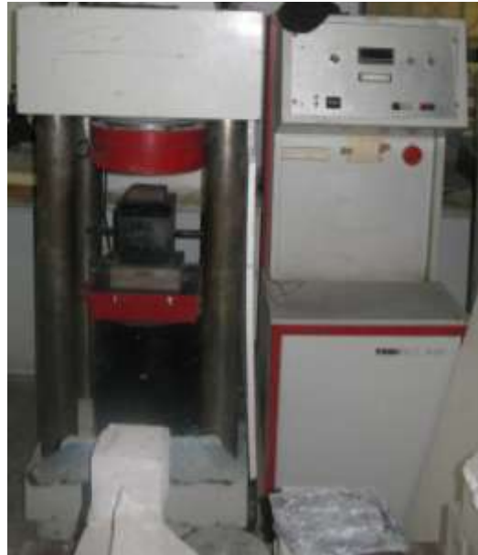
Σχήμα 50: Μηχανή δοκιμής σε μονοαξονική θλίψη – Εργαστήριο Οπλισμένου Σκυροδέματος ΕΜΠ
