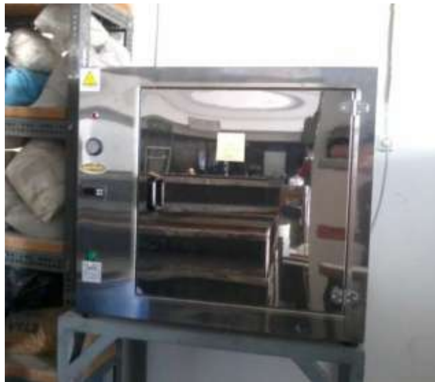
Σχήμα 35: Φούρνος ξήρανσης αδρανών
