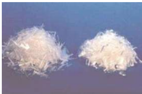
Σχήμα 15: Αριστερά: ινίδια ορθογωνικής διατομής, Δεξιά: ίνες κυκλικής διατομής (Kosmatka, Kerkhoff, Panarese 2002)
