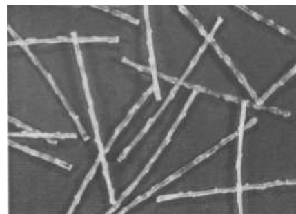
Σχήμα 16: Ίνες πολυπροπυλενίου Duomix, διάμετρος 18 \mu\text{m} , μήκος 6 mm (Bekaert)
