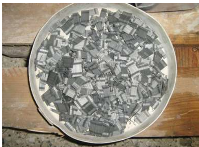
Σχήμα 34: Ίνες που χρησιμοποιήθηκαν στην παρούσα διπλωματική (με γαντζωτά άκρα)
