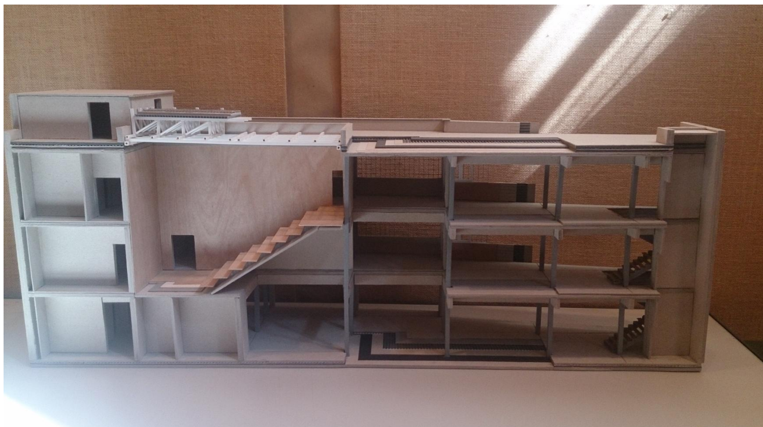
Εικόνα 82: Μακέτα κτηρίου κλίμακας 1:50 με κατασκευαστικές λεπτομέρειες.
