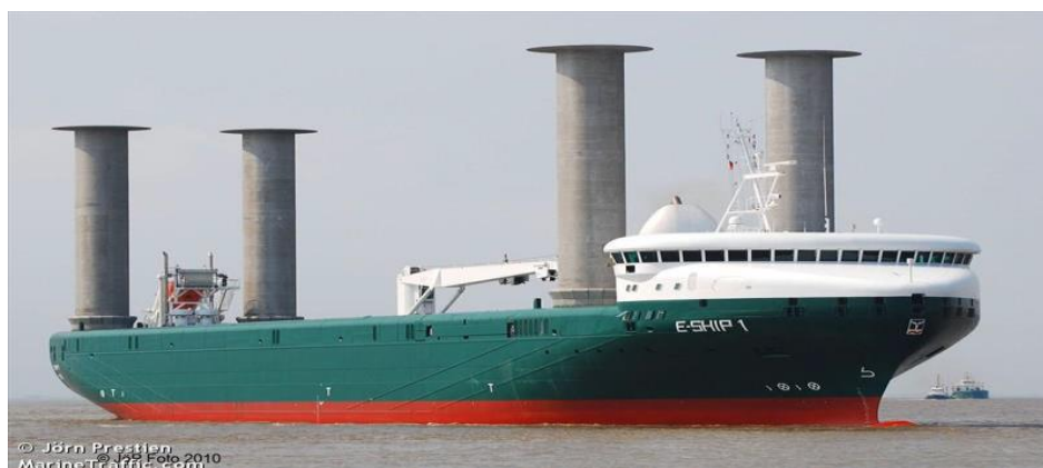
Εικόνα: Πλοίο(E-ship 1) με εγκατεστημένους κινητήρες Flettner.
