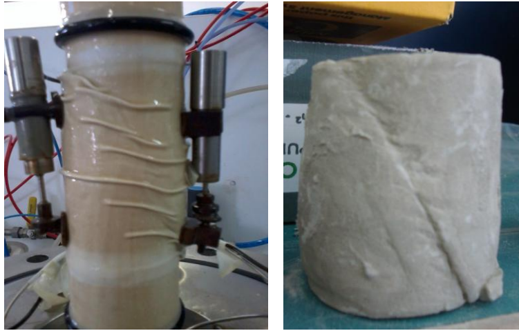
Εικόνα 5.2.1: Σχηματισμός επιπέδου αστοχίας κατά την τριαξονική δοκιμή.
