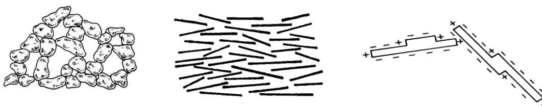
Σχήμα 2.1.1 : Τυπική διάταξη κόκκων άμμου και πλακιδίων αργίλου
