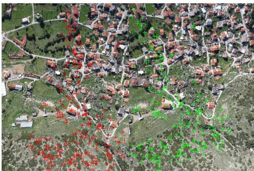
Σχήμα 7.34. Ομολογίες σημείων στο 1 ο στερεοζεύγος ύστερα από την αφαίρεση σημείων
