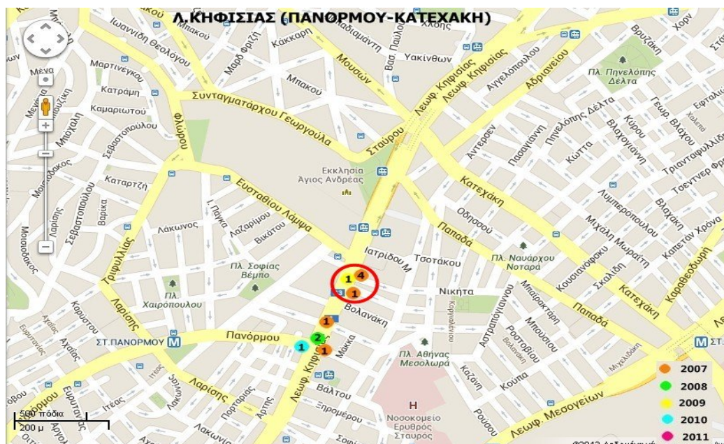
Εικόνα 5.13: Απεικόνιση των ατυχημάτων στο 3 ο επικίνδυνο τμήμα της λεωφόρου Κηφισίας για τα έτη 2007-2011 και των πιθανών θέσεων πεζογέφυρας.
