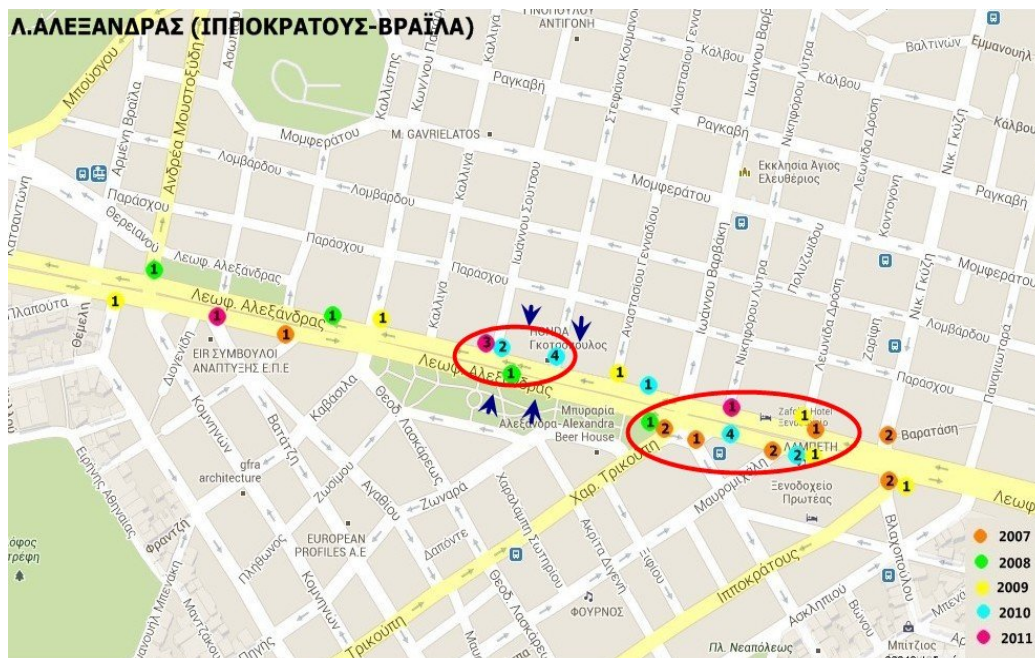
Εικόνα 5.1: Απεικόνιση των ατυχημάτων στο επικίνδυνο τμήμα της λεωφόρου Αλεξάνδρας για τα έτη 2007-2011 και των πιθανών θέσεων πεζογέφυρας.
