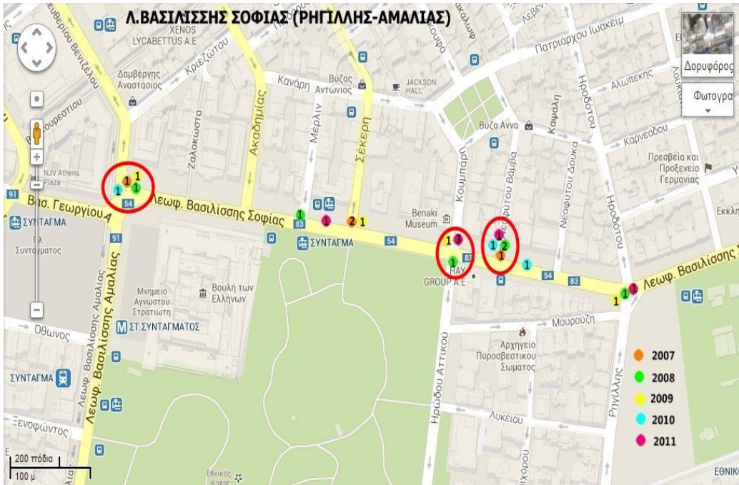
Εικόνα 5.11: Απεικόνιση των ατυχημάτων στο 2 ο επικίνδυνο τμήμα της λεωφόρου βασιλίσσης Σοφίας για τα έτη 2007-2011 και των πιθανών θέσεων πεζογέφυρας.
