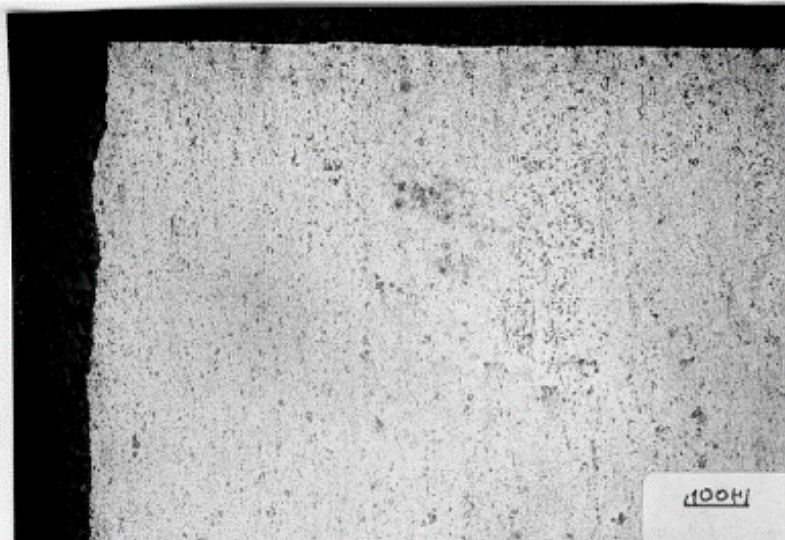
ΦΩΤΟ 1: Δοκίμιο Al7075-T0 Alclad κομμένο με ψαλίδι και τροχό. Διαμήκης Τομή.
