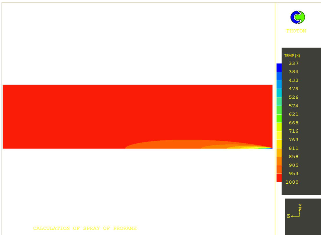
Εικόνα 6.11: Κατανομή της θερμοκρασίας για διάμετρο ακροφυσίου 0.68mm και καύσιμο προπάνιο σε πραγματικό χρόνο 10ms.
