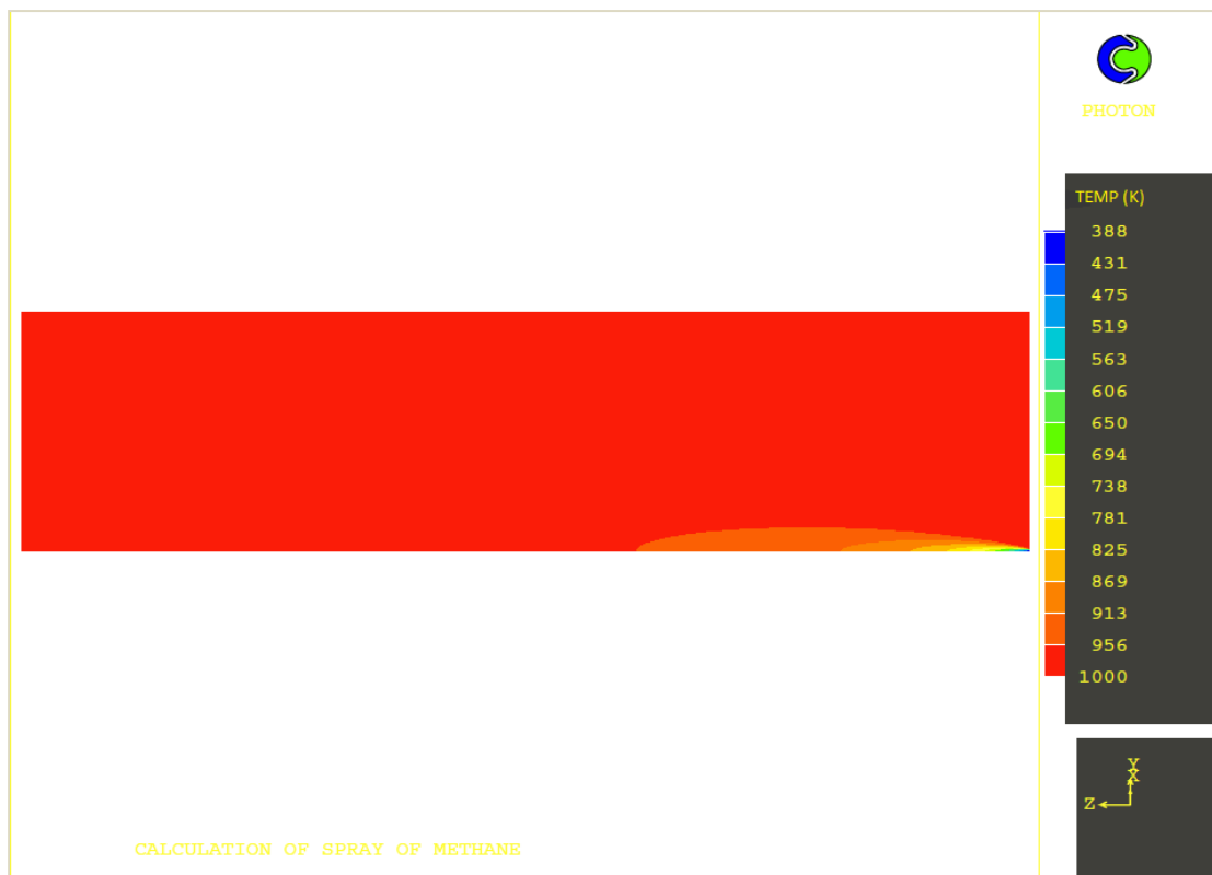
Εικόνα 6.3: Κατανομή της θερμοκρασίας για διάμετρο ακροφυσίου 0.68mm και καύσιμο μεθάνιο σε πραγματικό χρόνο 10ms.
