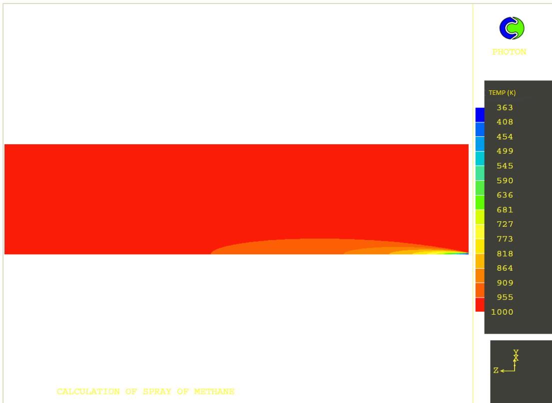
Εικόνα 6.7: Κατανομή της θερμοκρασίας για διάμετρο ακροφυσίου 1mm και καύσιμο μεθάνιο σε πραγματικό χρόνο 10ms.
