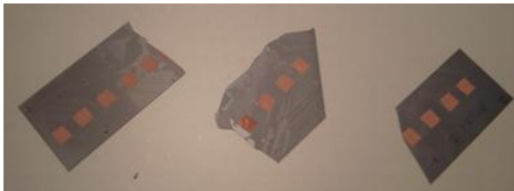
Εικόνα 8.1: Φωτογραφία δειγμάτων πολυκρυσταλλικού πυριτίου με SAMs και screen-printing χαλκού.
