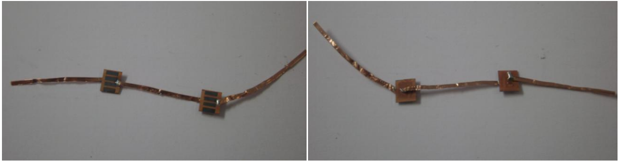
Εικόνα 9.4: Διασύνδεση δύο ηλιακών κελιών με σύρμα χαλκού και κόλληση κασσίτερου (μπρος και πίσω πλευρά).
