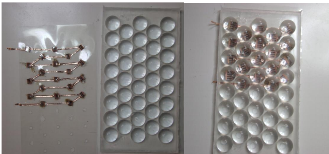
Εικόνα 9.6: Το δίκτυο των ηλιακών κελιών πριν και αφού κολληθεί στο πλέγμα των φακών.
