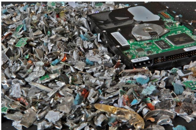
**Εικόνα 5: Το αποτέλεσμα του τεμαχισμού ενός δίσκου. Πηγή: (UNTHA, 2014)**
