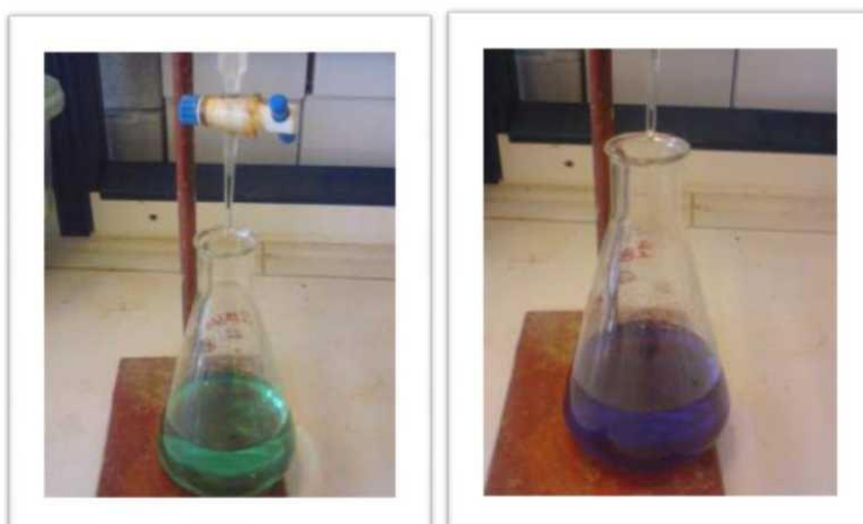
Εικόνα 47: Πριν και μετά τη τιτλοδότηση κατά τη μέθοδο προσδιορισμού του αζώτου των δειγμάτων
