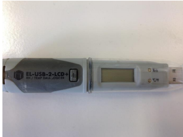
Εικόνα 35: Αισθητήρας μέτρησης θερμοκρασίας και σχετικής υγρασίας
