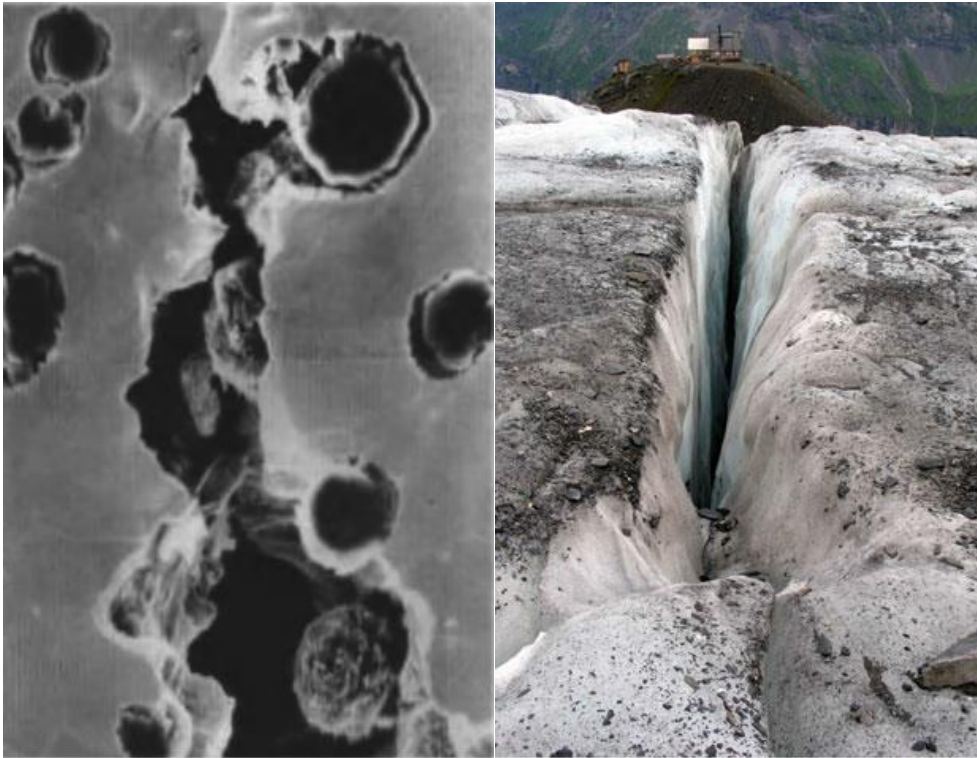
Εικόνα 1.1. Αριστερά: Μικρορωγμή σε πλάστιμο σίδηρο. Δεξιά: Μακρορωγμή σε κομμάτι πάγου[1].
