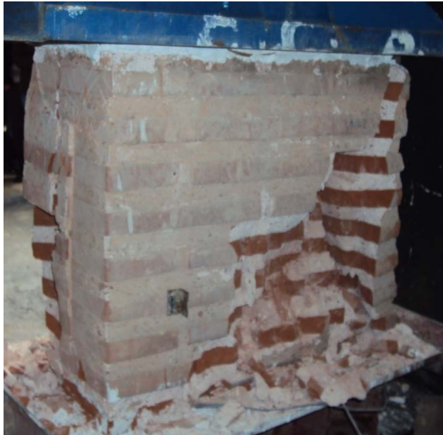
Εικόνα 3.3 Δοκίμιο NHL 2 – Πίσω όψη, τελική κατάσταση.
