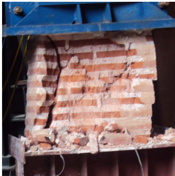
Εικόνα 3.2 Δοκίμιο NHL 2 - Εμπρόσθια όψη, τελική κατάσταση.
