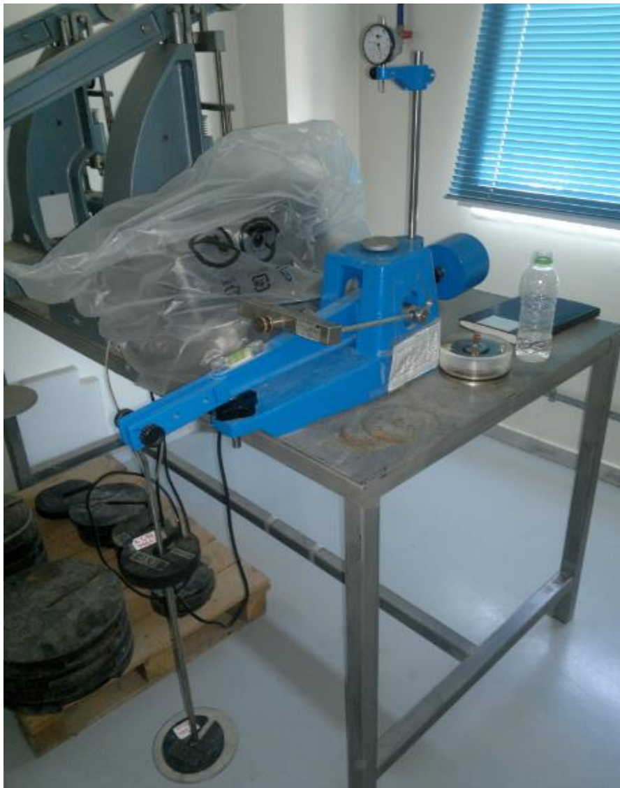
Εικόνα 3.5 Η συσκευή Matest S260 που χρησιμοποιήθηκε στις δοκιμές
