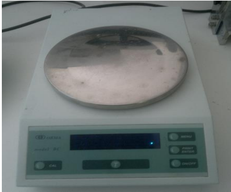
Εικόνα 2.2 Ζυγαριά ακριβείας \pm 0,01\text{gr} για τον υπολογισμό των βαρών
