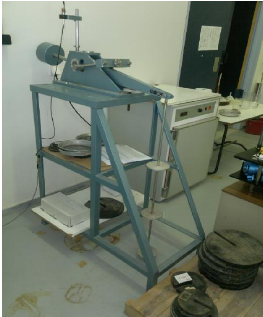
Εικόνα 3.6 Η συσκευή Wykeham Farrance 24255 που χρησιμοποιήθηκε στις δοκιμές
