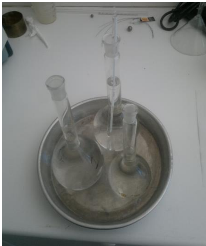
Εικόνα 2.1 Γυάλινες φιάλες για τον υπολογισμό του G_s
