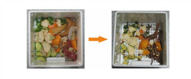
Εικόνα 6.2: Κάδος οικιακού ξηραντή Loofen LF – 07 πριν και μετά τη ξήρανση.
