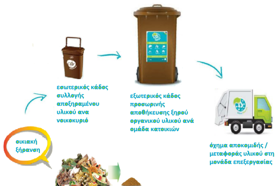
Εικόνα 6.11 : Σχηματική απεικόνιση της πρώτης φάσης του επενδυτικού σχεδίου (Οικιακή ξήρανση - Συλλογή – Μεταφορά) (Πηγή: Ιδία επεξεργασία)
