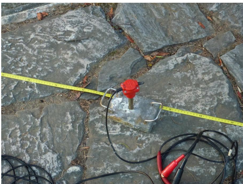
Εικόνα 4.15: Το ειδικό μολυβένιο πλακίδιο που χρησιμοποιήθηκε σε περιπτώσεις που δεν υπήρχε στο έδαφος χώμα.
