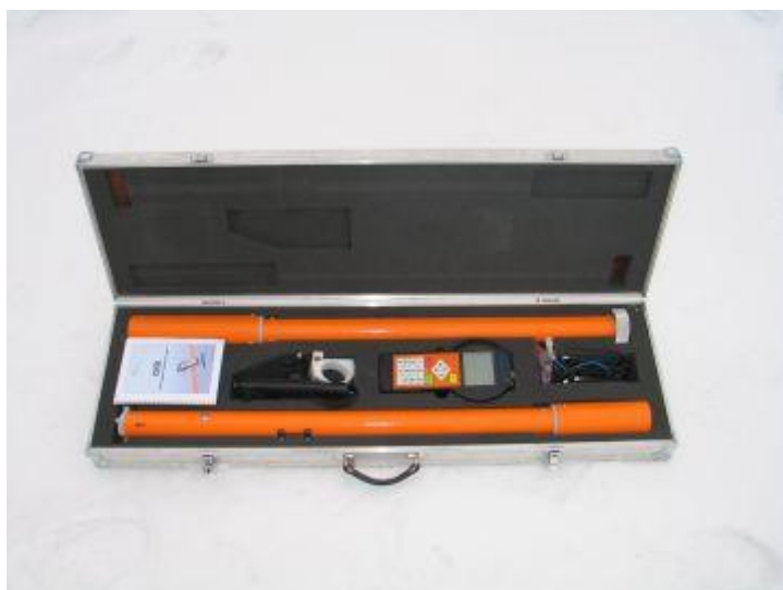
Εικόνα 4.8: Το ηλεκτρομαγνητικό όργανο CMD της GF Instruments (CMD, Electromagnetic Conductivity Meter User Manual)
