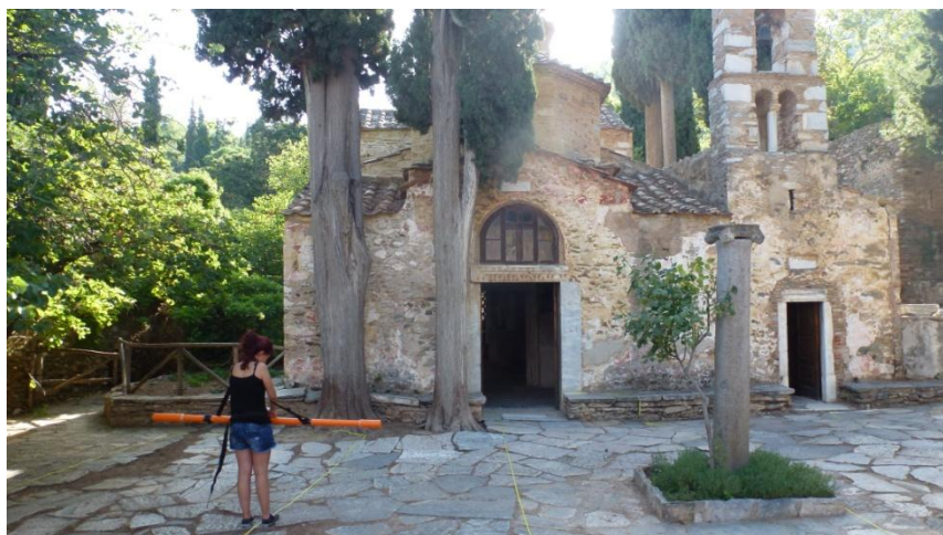
Εικόνα 4.6: Μετρήσεις με το ηλεκτρομαγνητικό όργανό στη Μονή Καισαριανής
