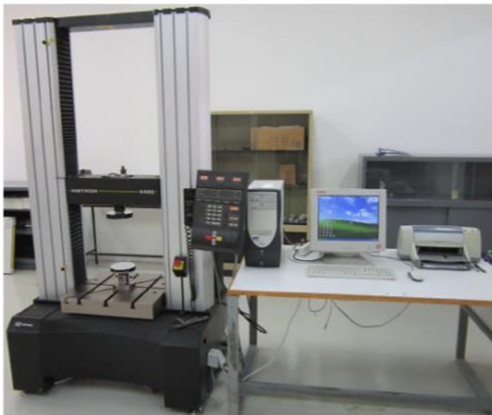
Εικόνα 3.4: Συνολική διάταξη της μηχανικής πρέσας INSTRON του εργαστηρίου
