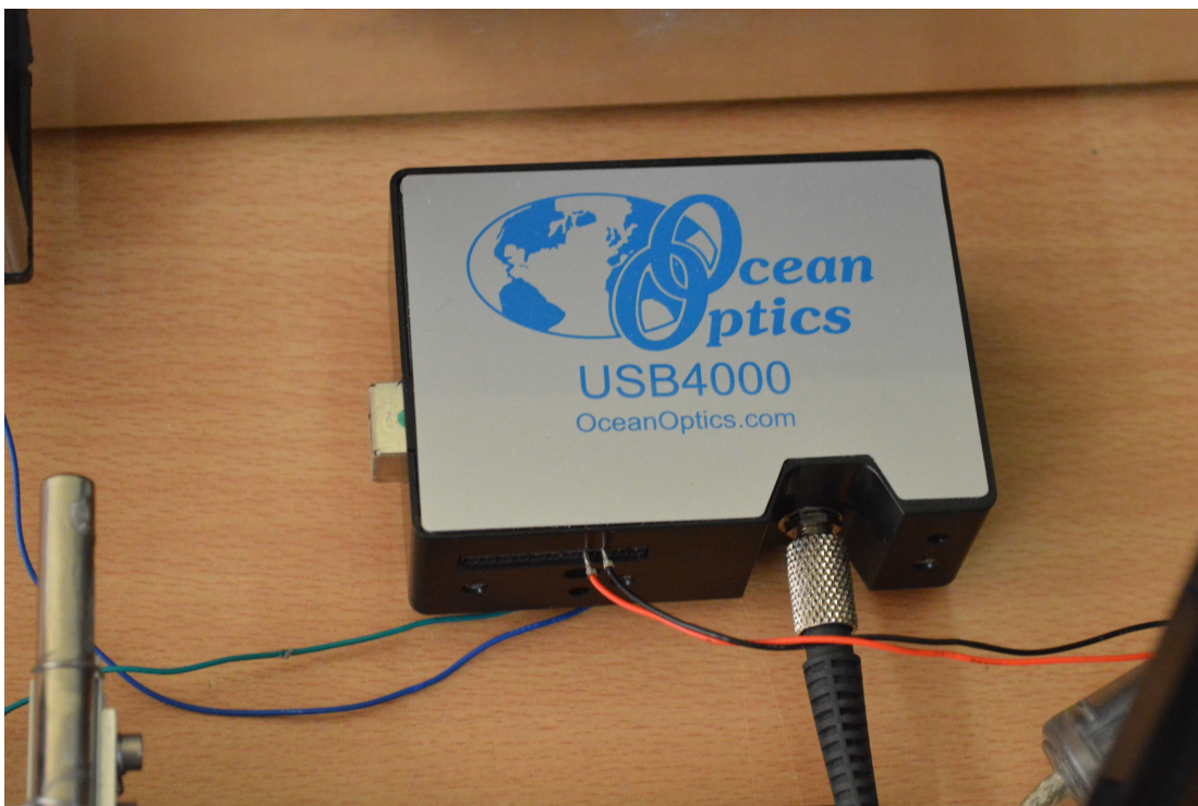
Εικόνα 5.3: Φασματόμετρο USB4000 από την Ocean Optics
