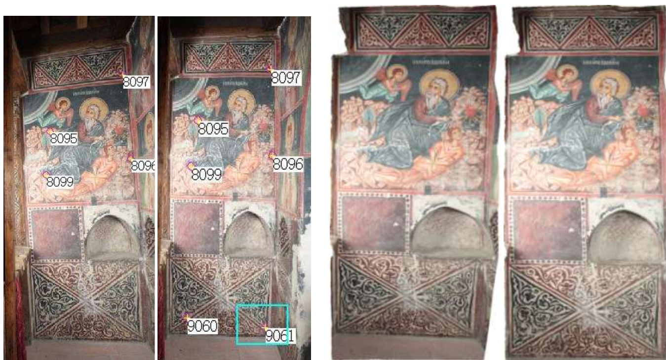
Εικόνα 4.13: Στοχεύσεις σημείων λεπτομέρειας πριν και μετά τη διόρθωση (αριστερά) και ορθοφωτογραφίες πριν και μετά τη διόρθωση (δεξιά)
