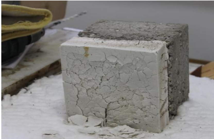
Εικόνα 4-32 Δοκίμιο δοκιμής παθητικής πυροπροστασίας (σκυρόδεμα + γεωπολυμερές υλικό), μετά την δοκιμή
