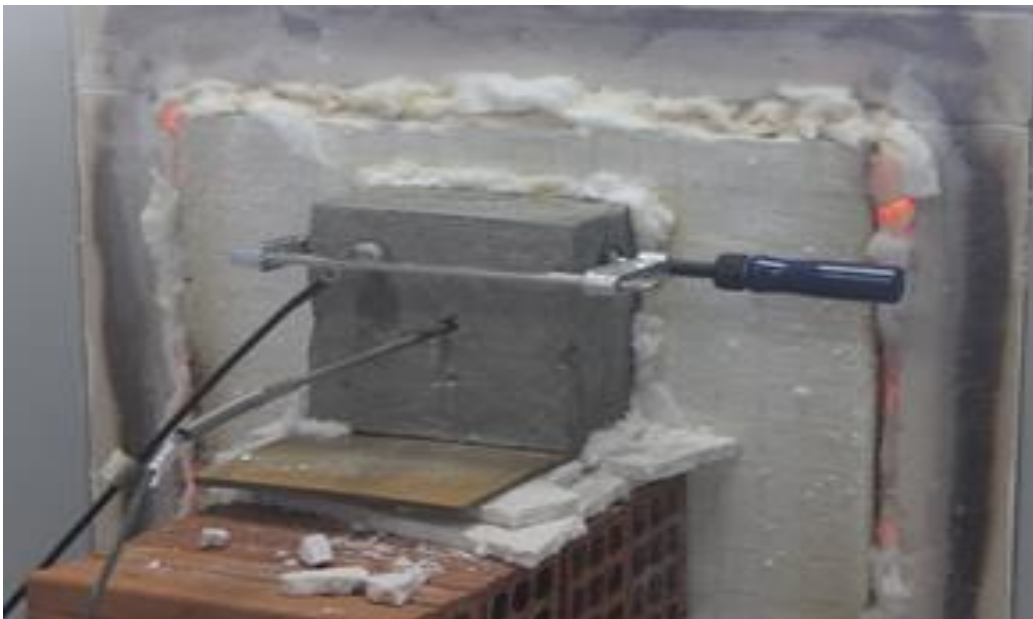
Εικόνα 4-17 Φούρνος με τοποθετημένο το δοκίμιο για την πρότυπη δοκιμή ελέγχου παθητικής πυροπροστασίας.
