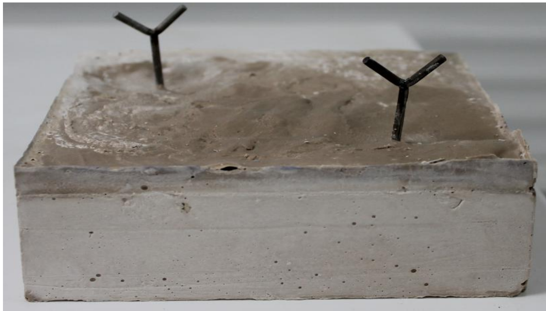
Εικόνα 4-19 Γεωπολυμερές με τα αγκύρια που θα χρησιμοποιηθεί σαν υλικό πυροπροστασίας
