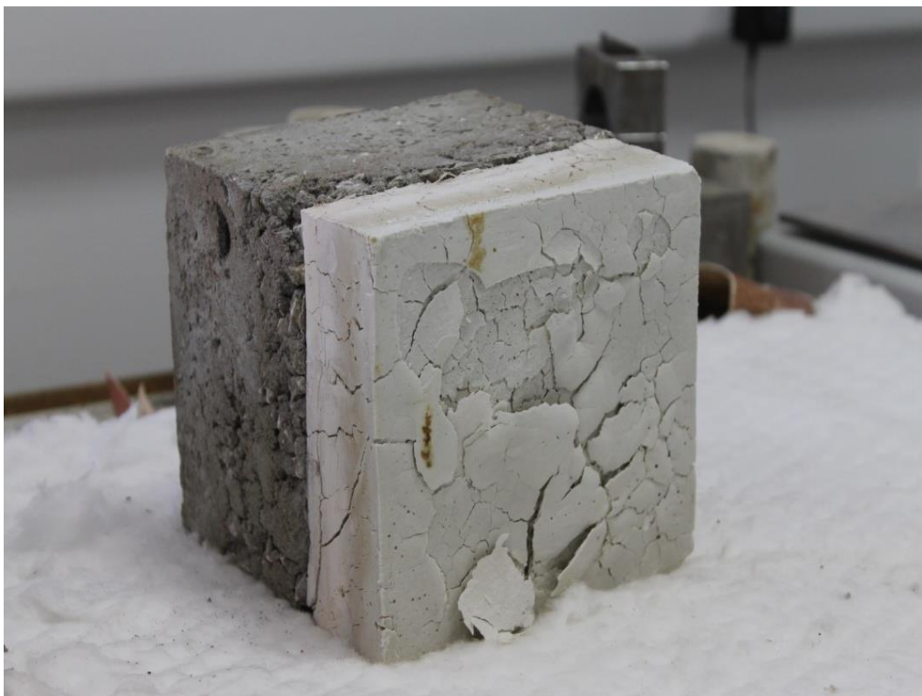
Εικόνα 4-31 Δοκίμιο δοκιμής παθητικής πυροπροστασίας (σκυρόδεμα + γεωπολυμερές υλικό), μετά την δοκιμή
