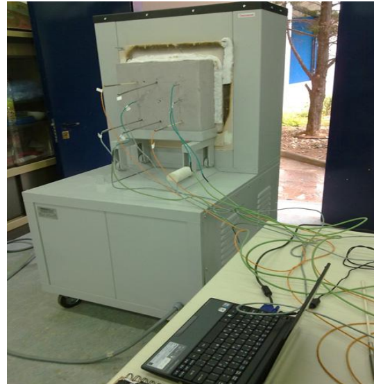
Εικόνα 4-16 Πρότυπη συσκευή ελέγχου πυροπροστασίας & διεξαγωγή πειράματος σε αυτή
