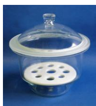
Εικόνα 4-9 Ξηραντήρας και δοχείο απιονισμένου νερού για την μέτρηση της υδατοαπορροφητικότητας.
