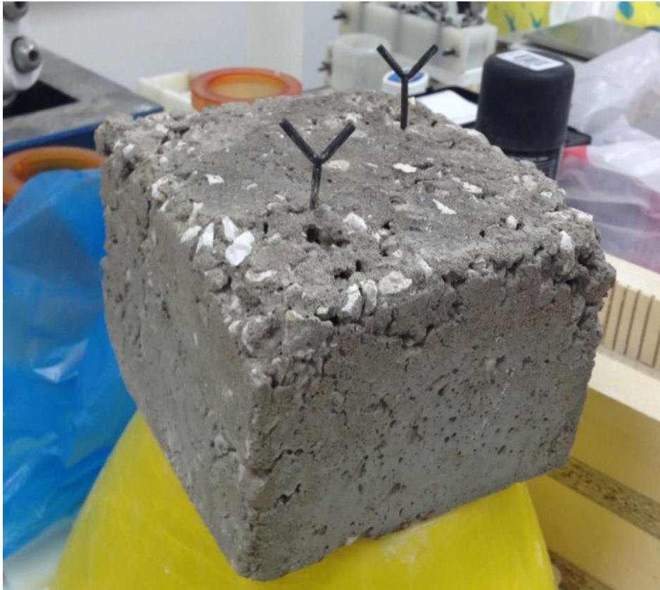
Εικόνα 4-35 Δοκίμιο σκυροδέματος μετά την δοκιμή παθητικής πυροπροστασίας
