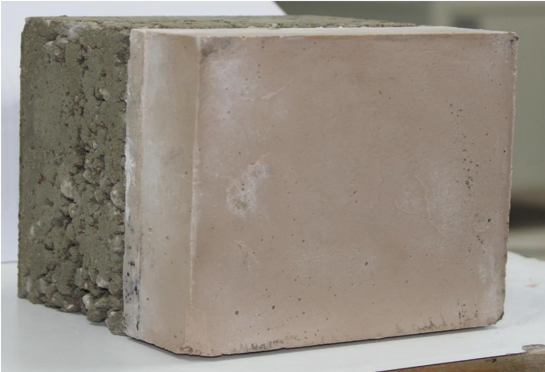
Εικόνα 4-20 Τελικό δοκίμιο προς δοκιμή από σκυρόδεμα και αγκυρωμένο σε αυτό γεωπολυμερές
