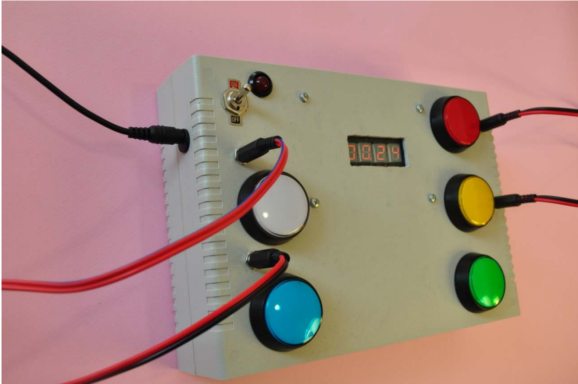
Εικόνα 40. Κεντρική μονάδα καταμέτρησης επαναλήψεων (counter). Δίπλωμα εφευρετικής του ιδίου με αριθμό 20150100063.
