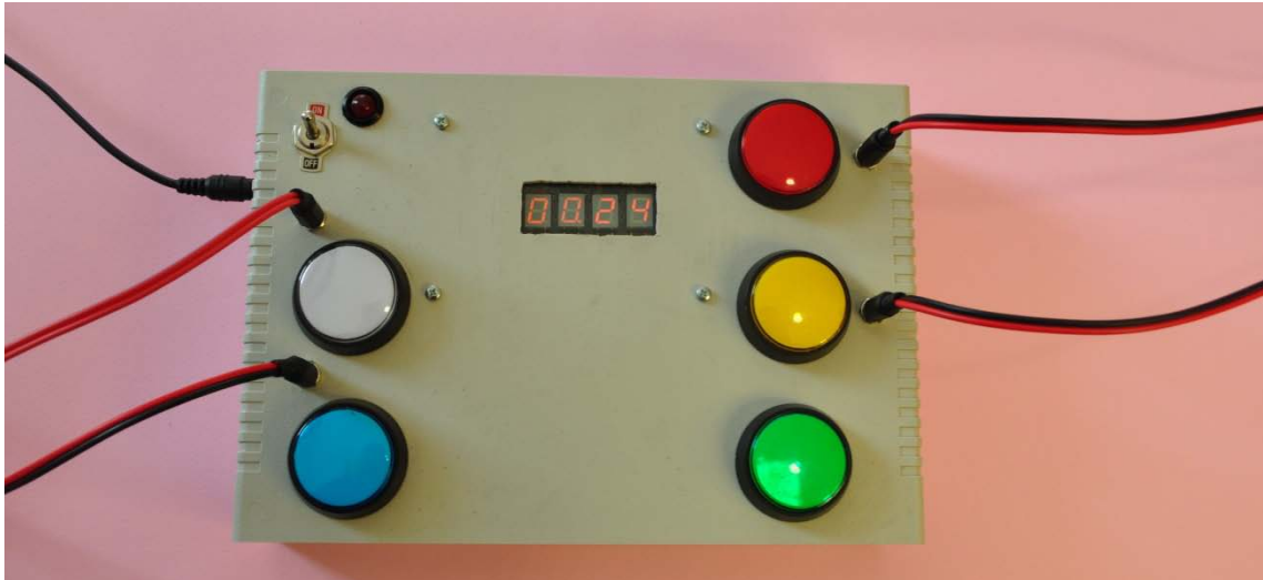
Εικόνα 41. Κεντρική μονάδα καταμέτρησης επαναλήψεων (counter). Δίπλωμα ευρεσιτεχνίας του ιδίου με αριθμό 20150100063.
