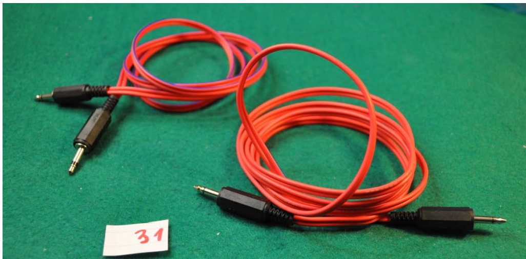
Εικόνα 34. Εύκαμπτα καλώδια 2 \times 0,75 \text{ mm}^2 συνδεδεμένα με φις.
