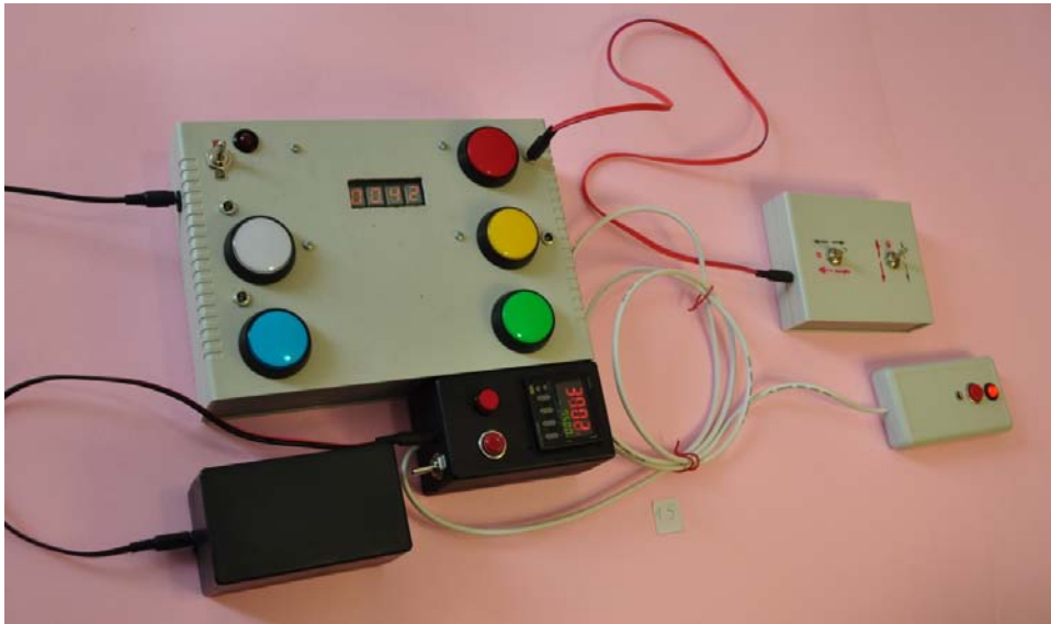
Εικόνα 58. Κεντρικές μονάδες counter και timer ενωμένες με την ίδια περιφερειακή μονάδα για μέτρηση ταχύτητας και αντοχής της περιστροφής του διακόπτη δεξιά - αριστερά και πάνω - κάτω. ©
