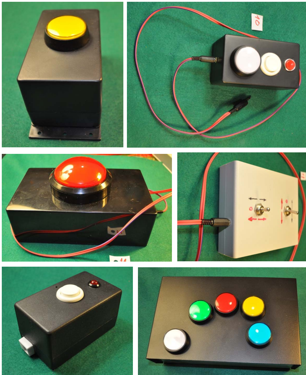
Εικόνα 35. Μερικές από τις περιφερειακές μονάδες που επινόησε και κατασκεύασε ο συγγραφέας. Δίπλωμα ευρεσιτεχνίας με αριθμό 20150100063.
