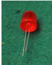
Εικόνα 28. Λαμπάκι led (φωτοдиодος).
