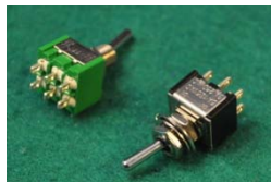
Εικόνα 50. Κεντρικοί διακόπτες on –off του εμπορίου.
