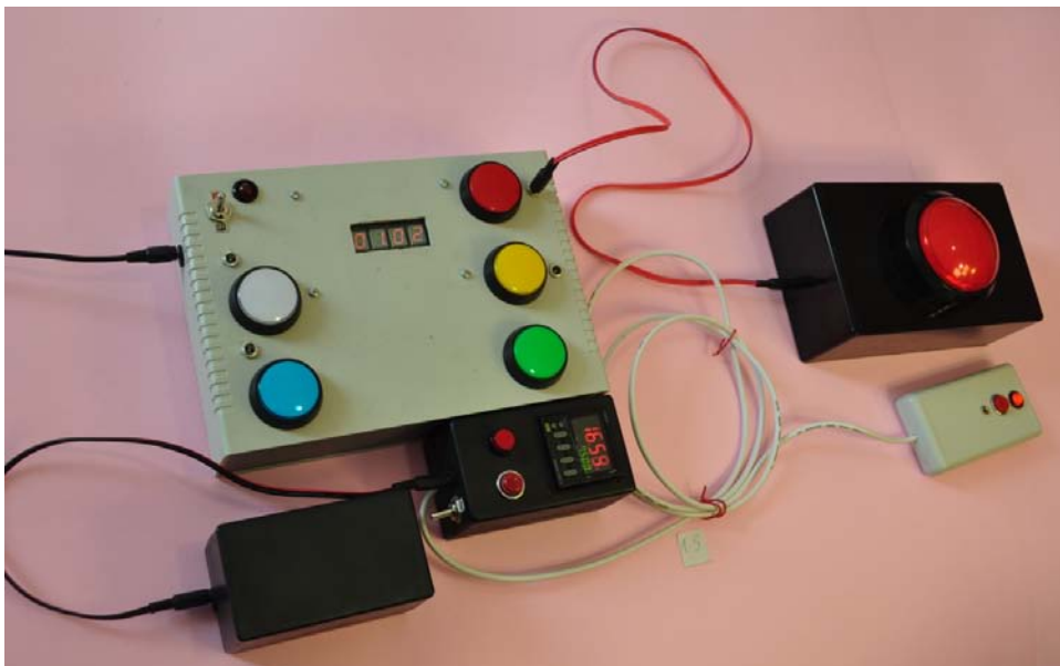
Εικόνα 59. Κεντρικές μονάδες counter και timer ενωμένες με την ίδια περιφερειακή μονάδα για μέτρηση ταχύτητας και αντοχής παλαμιαίας κάμψης του καρπού ή των τεσσάρων δακτύλων. ©
