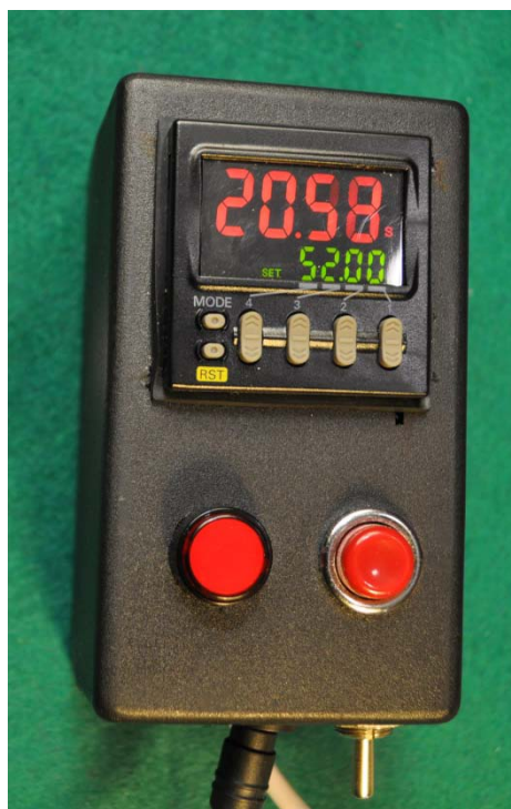
Εικόνα 11. Όψεις της Κεντρικής Μονάδας Μέτρησης Χρόνου (timer) που χειρίζεται ο γιατρός. Δίπλωμα ερευνητικής με αριθμό 2015010063.
