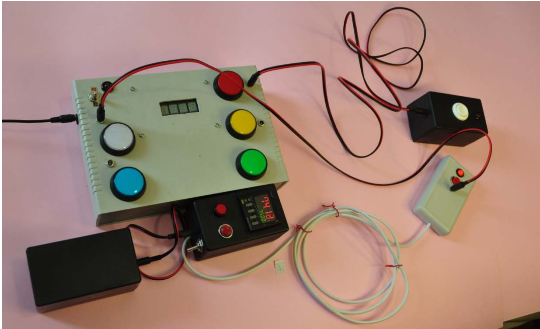
Εικόνα 57. Κεντρικές μονάδες counter και timer ενωμένες με την ίδια περιφερειακή μονάδα για μέτρηση ταχύτητας και αντοχής της πίεσης των δακτύλων σε μπουτόν 170gr δύναμης. ©
