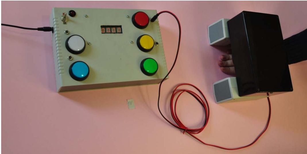
Εικόνα 55. Ένωση κεντρικής μονάδας counter με περιφερειακή μονάδα τοποθετημένη ανάποδα για μέτρηση ραχιαίας κάμψης καρπού και δακτύλων. ©
