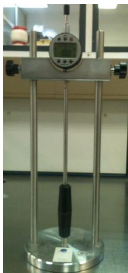
Σχήμα 21: Συσκευή εκτίμησης διόγκωσης, μέσω της μεταβολής μήκους
