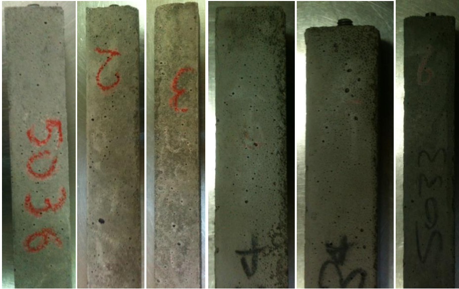
Σχήμα 42: Μικρορηγματώσεις και αλλοιώσεις ακμών δοκιμίων (3 μήνες)
