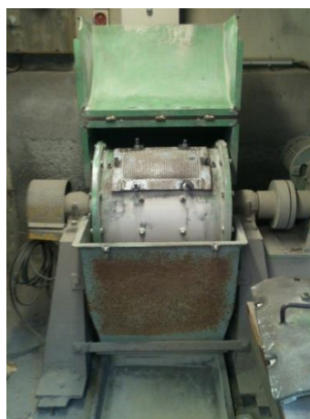
Σχήμα 14: Εργαστηριακός σφαιρόμυλος χωρητικότητας πέντε (5) Kg
