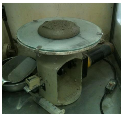
Σχήμα 19: Πειραματική διάταξη εξάπλωσης
