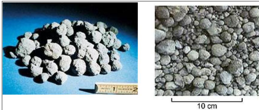
Σχήμα 2: Σφαιρίδια (pellets) μεγέθους 10-25 mm του κλίνκερ τσιμέντου
