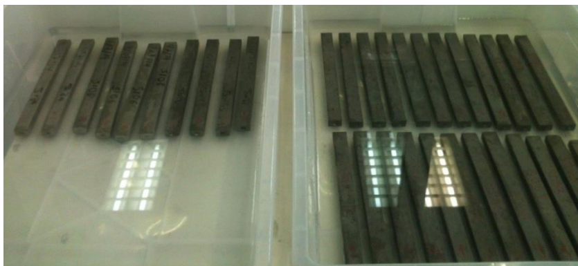
Σχήμα 18: Εμβαπτισμένα πρίσματα σε διάλυμα θειϊκού νατρίου
