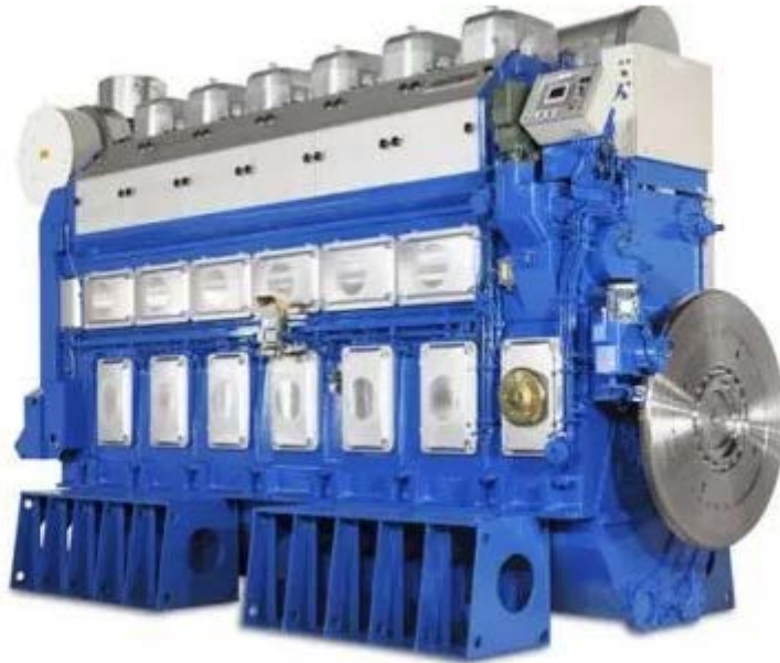
Σχήμα 2.5: Wartsila 6L50DF. Αποδίδει 5700kW στις 500rpm
