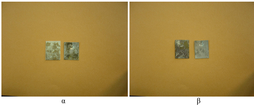
Εικόνα 3.39. α:Το δοκίμιο 7 χωρίς επεξεργασία και το 3 καθαρισμένο,β:το δοκίμιο 8 με τεχνητή πατίνα \text{AgCl/CuCl} και το 4 καθαρισμένο.
