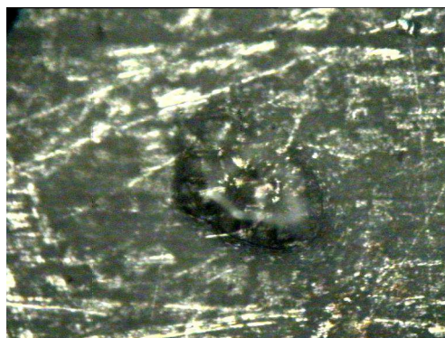
Εικόνα 3.24.:Το δοκίμιο 34 μετά τον καθαρισμό του με alkaline dithionite,σε μεγέθυνση 200 α:πριν και β:μετά την εφαρμογή της μεθόδου Tafel και ενώ έχει προηγηθεί διπλή επίστρωση Paraloid-72.
