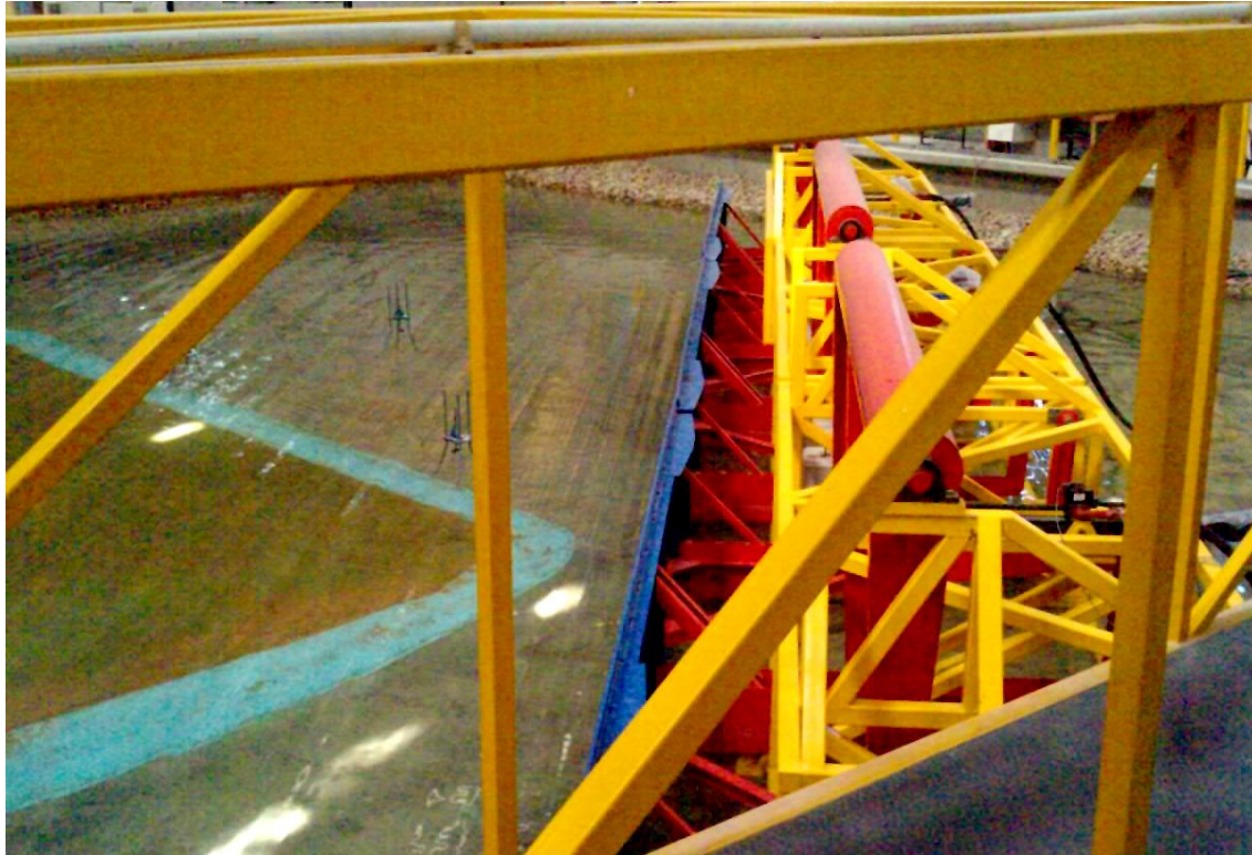
Εικόνα 3.3: Κυματιστήρες που χρησιμοποιήθηκαν στις μετρήσεις σε διεύθυνση 45^\circ
