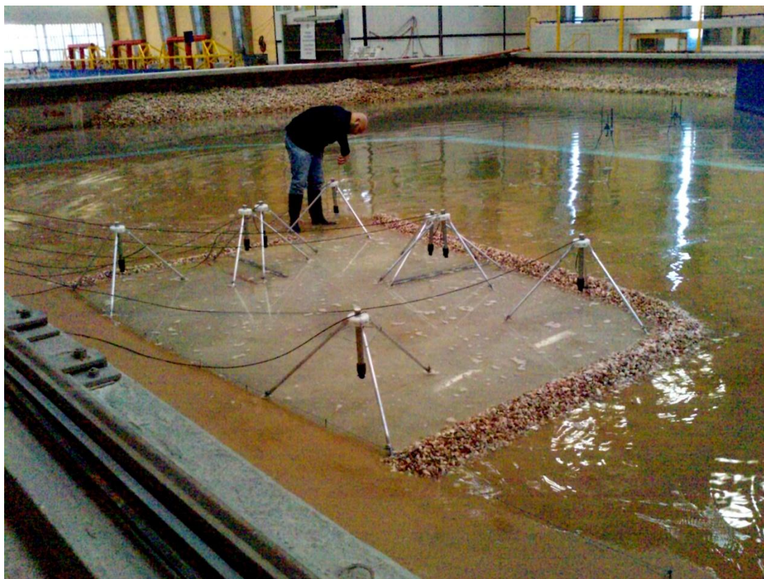
Εικόνα 4.5: Τοποθέτηση ηχοβολιστικών μετρητών στο προσομοίωμα
