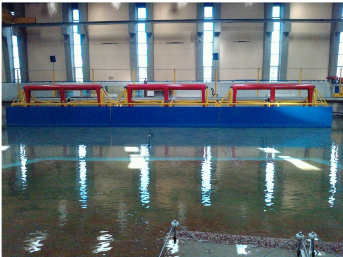
Εικόνα 3.2: Όψη των τριών κυματιστήρων που χρησιμοποιήθηκαν στις μετρήσεις
