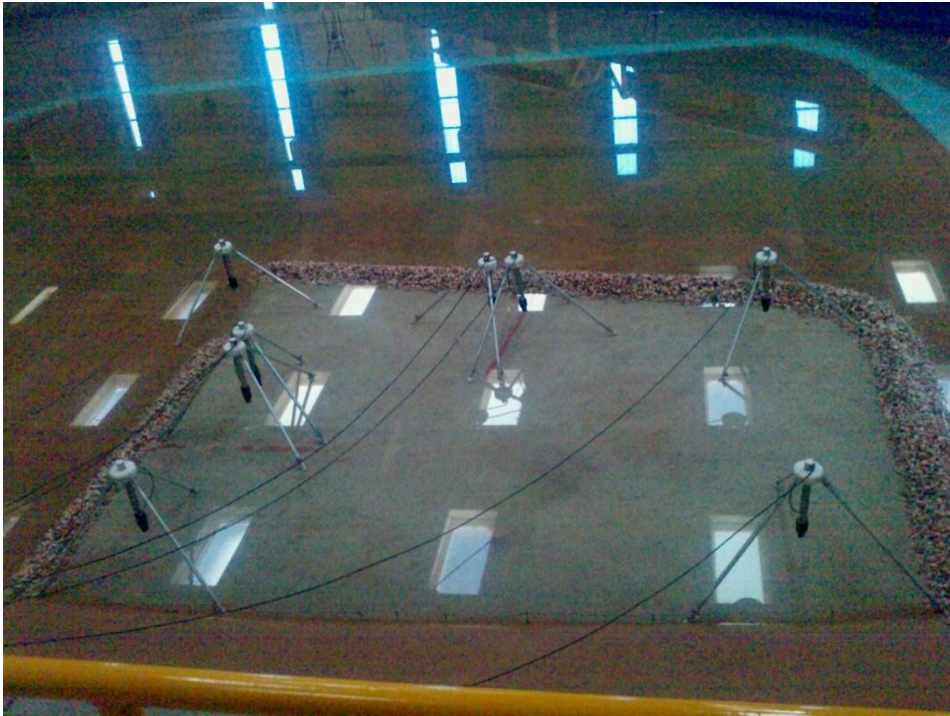
Εικόνα 4.6: Η μέτρηση μηδέν σε πλήρη ηρεμία επιφάνειας δεξαμενής
