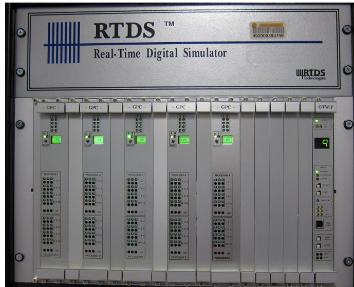
Εικόνα 4.1 Ψηφιακός προσομοιωτής πραγματικού χρόνου (RTDS)
