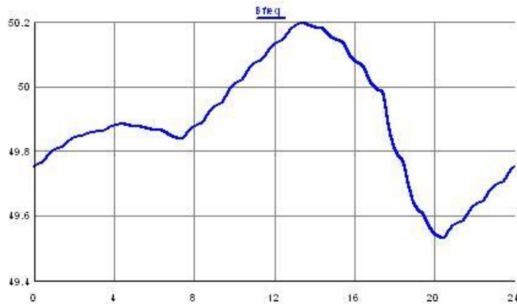
Εικόνα 5.34 Ημερήσια μεταβολή της συχνότητας κατά τη νησιδοποιημένη λειτουργία του μικροδικτύου (οριζόντιος άξονας: χρόνος, κάθετος άξονας: συχνότητα σε Hz)
