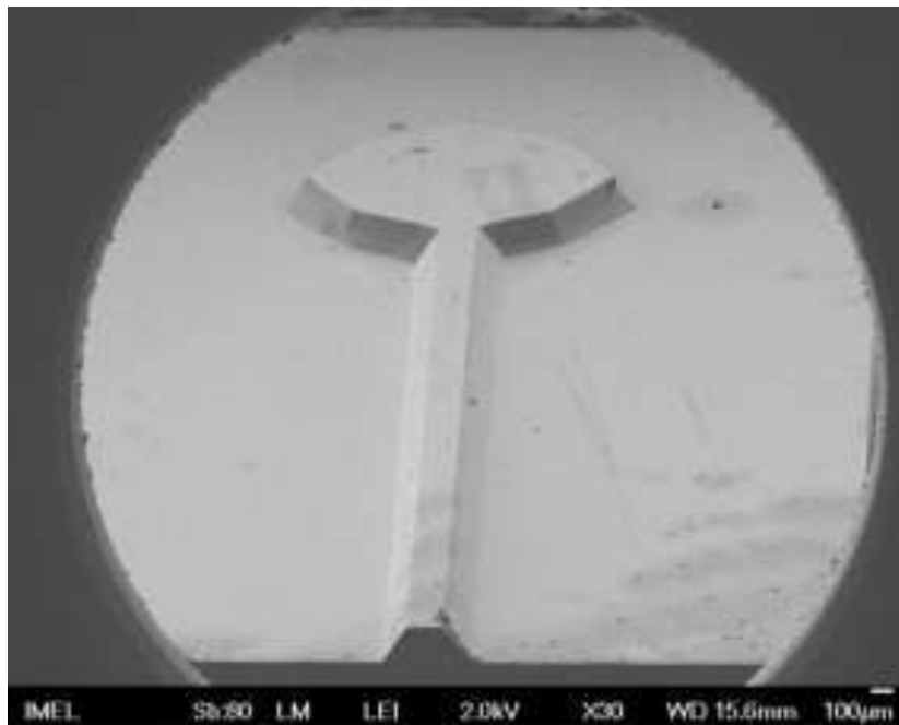
Εικόνα 3.4: Εικόνα από μικροσκόπιο ηλεκτρονικής δέσμης (SEM) του προτύπου (master) ύστερα από την ανιστροπικήεγχάραξη στο καυστικό κάλιο.
