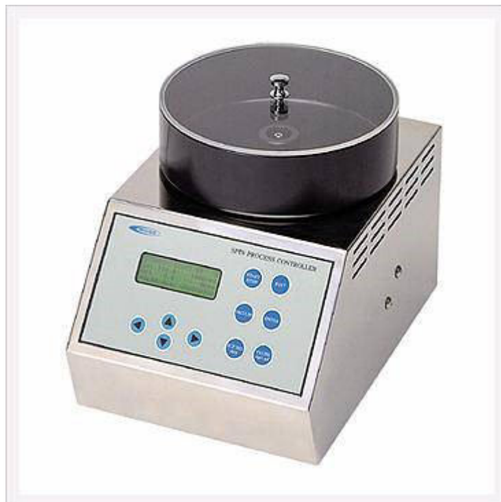
Εικόνα 3.2: Τυπικός spin coater της Midas Systems Co Ltd. που χρησιμοποιήθηκε στα πειράματα.
